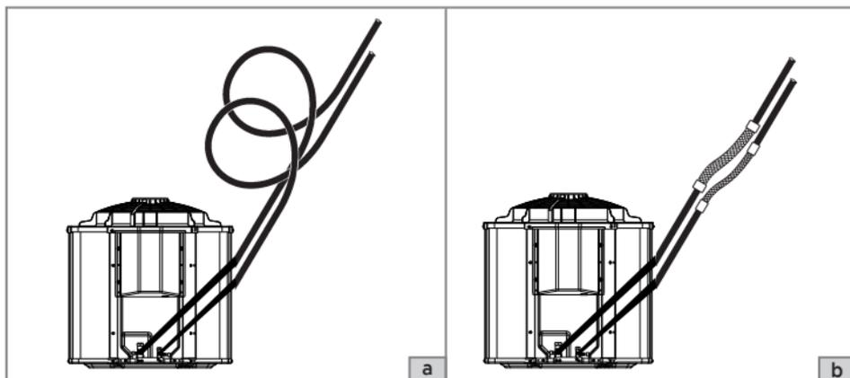
FIG. 31 - INSTALAÇÃO DOS LOOP'S E TUBOS FLEXÍVEIS
