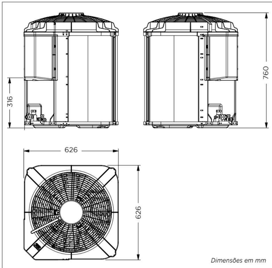
FIG. 10b - DIMENSIONAL UNIDADES CONDENSADORAS 38CCVD60
