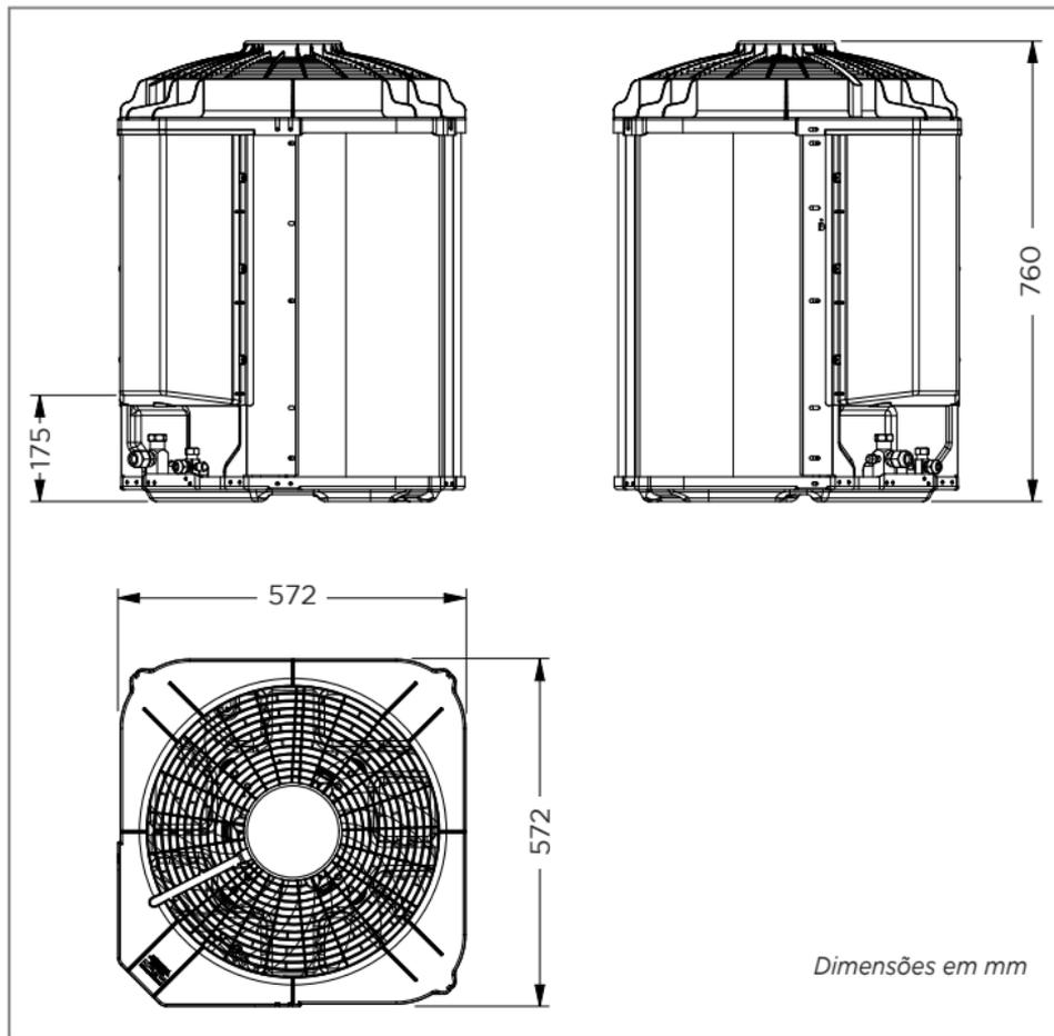
FIG. 10a - DIMENSIONAL UNIDADES CONDENSADORAS 38CCVD36
