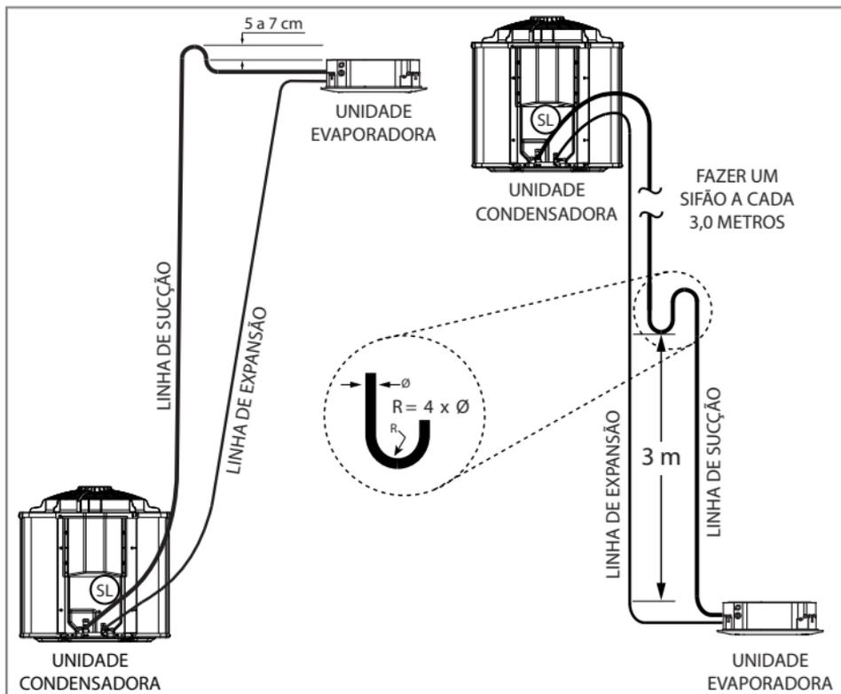
FIG. 30 - INSTALAÇÃO LINHAS DE INTERLIGAÇÃO
