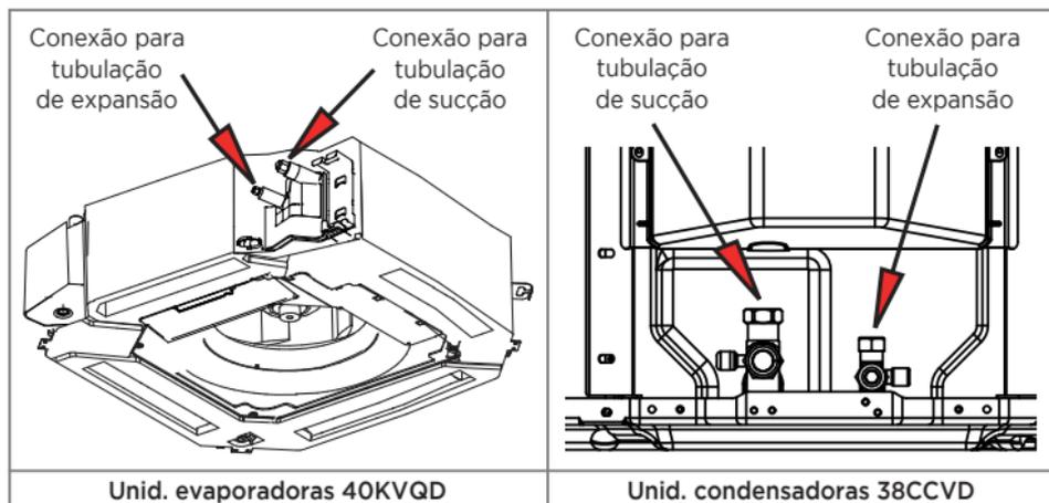
FIG. 32 - CONEXÕES DE INTERLIGAÇÃO
