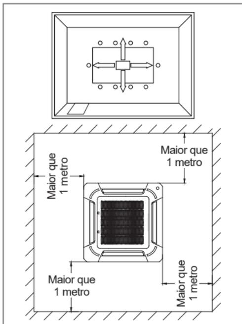
FIG. 11 - EXEMPLO DE UN. EVAPORADORA EM AMBIENTE CORPORATIVO
