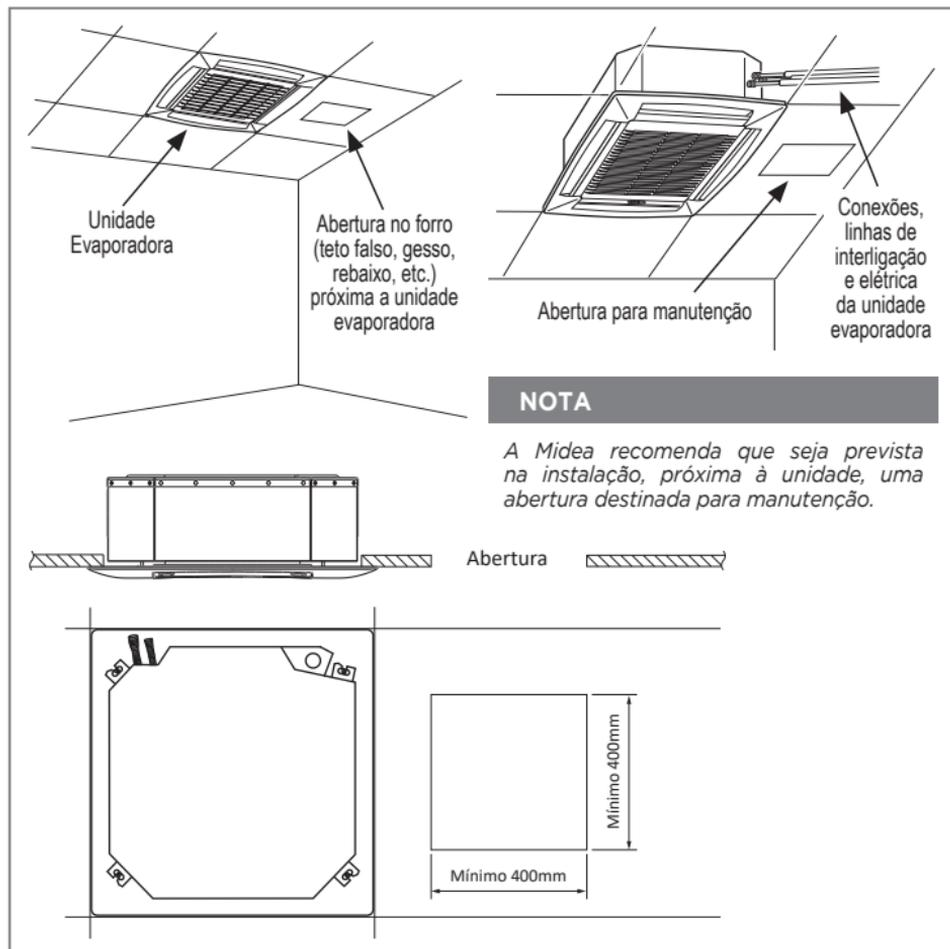
FIG. 17 - ABERTURA PARA MANUTENÇÃO - DIMENSIONAL
