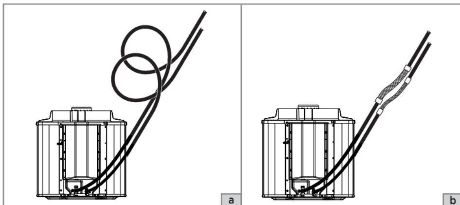
FIG. 28 - INSTALAÇÃO DOS LOOP'S E TUBOS FLEXÍVEIS
