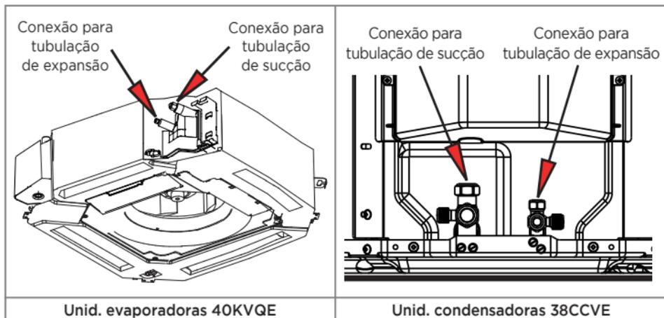
FIG. 29 - CONEXÕES DE INTERLIGAÇÃO
