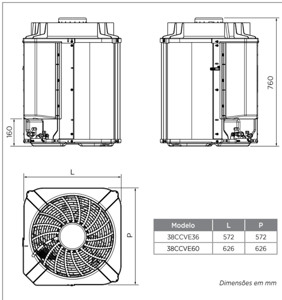
FIG. 6 - DIMENSIONAL UNIDADES CONDENSADORAS 38CCVE36/ 38CCVE60
