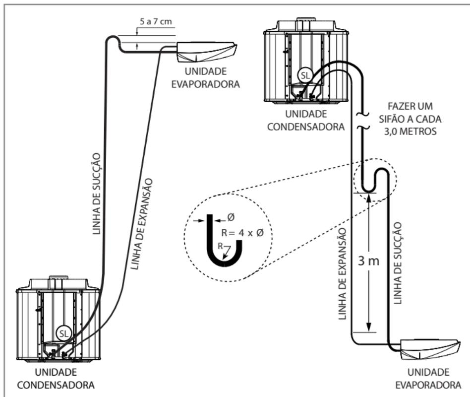
FIG. 27 - INSTALAÇÃO LINHAS DE INTERLIGAÇÃO
