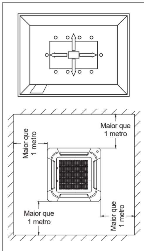
FIG. 7 - EXEMPLO DE UN. EVAPORADORA EM AMBIENTE CORPORATIVO
