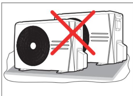
FIG. 2 - EVITAR INSTALAÇÃO EM SEQUÊNCIA
