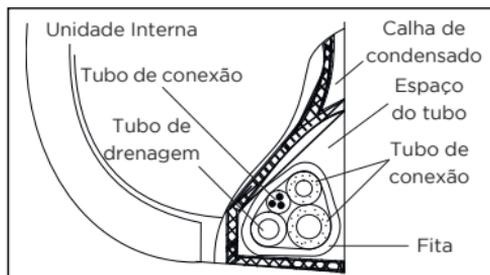
FIG. 8 - TUBO DE CONEXÕES
