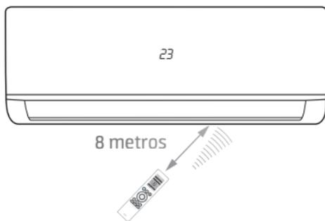
Posicionar o controle remoto de modo que os sinais enviados possam alcançar facilmente o receptor da unidade interna (a uma distância máxima de 8 metros).
