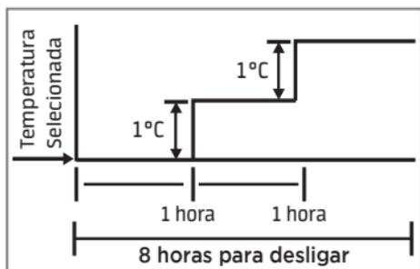
Quando em modo de operação REFRIGERAÇÃO (COOL) a temperatura atual configurada aumentará 1°C por hora nas primeiras duas horas, mantendo-se então estável nesta temperatura, pelas próximas 6 horas.
