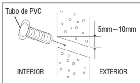
Veja na Fig. 11 as dimensões para furação da tubulação de interligação conforme cada capacidade.
