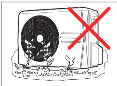
FIG. 1 - DESNIVELAMENTO UN. CONDENSADORAS
