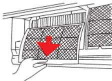
4. Reintroduzir a parte superior do filtro de ar na unidade observando para que a beirada direita e externa estejam perfeitamente alinhadas; recolocar o filtro.
