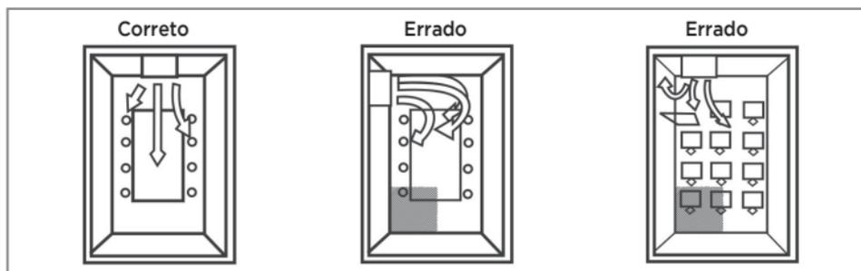
FIG. 5 - POSICIONAMENTO DA UNIDADE EVAPORADORA NO AMBIENTE
