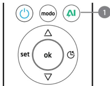
Pressione a tecla ECOMASTER quando estiver nos modos REFRIGERAÇÃO (COOL) ou AQUECIMENTO (HEAT), a velocidade do ventilador será alterada para Auto, a temperatura definida permanecerá inalterada, proporcionando uma sensação de maior conforto, economia de energia e com flutuação de temperatura reduzida.
