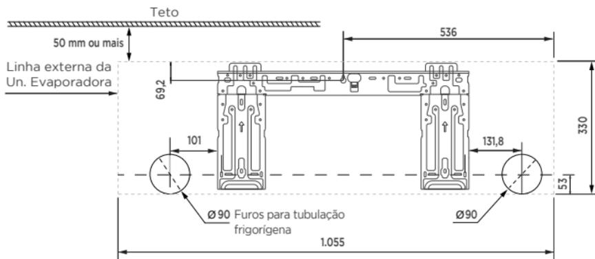
FIG. 11 - SUPORTES DE MONTAGEM
