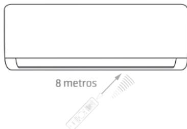
Posicionar o controle remoto de modo que os sinais enviados possam alcançar facilmente o receptor da unidade interna (a uma distância máxima de 8 metros).
