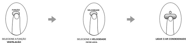
Na função VENTILAÇÃO , a temperatura não poderá ser definida. Como resultado, nenhuma temperatura é exibida no display do controle remoto.
