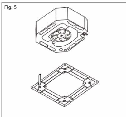
6. Aperte os quatro parafusos de regulagem das presilhas de fixação do painel, conforme indicado na figura 5, até que os espaços existentes entre as gaxetas de vedação do painel e a unidade interna sejam vedados.
