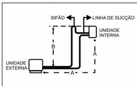
4. Para aparelhos instalados com distância entre 2 à 3 metros, recomendamos a preparação de um looping de aproximadamente 30 cm nas tubulações, conectando-as nas válvulas de serviço, evitando vibrações e consequentes trincas e vazamentos nesta região. Os loopings podem ser eventualmente substituídos por tubos flexíveis.
