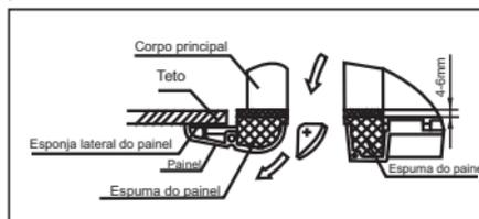
5. Alinhe o painel frontal ao corpo principal, levando em consideração a posição da tubulação e os lados de drenagem. Pendure as quatro travas do painel decorativo nos ganchos da unidade interna.
