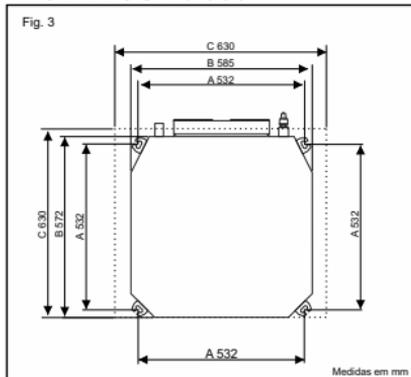
A = Distância entre os parafusos de instalação
