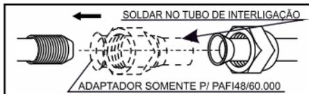
3. Finalmente aperte as conexões utilizando duas chaves, estando uma delas apoiada no tampão da válvula de serviço. Tenha o cuidado de não permitir a torção dos tubos.
