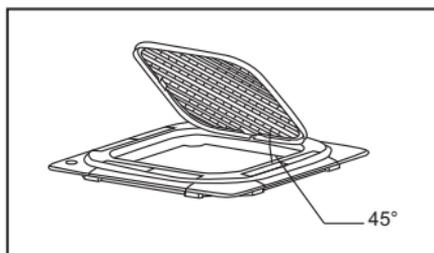
4. Remova as tampas de instalação nos quatro cantos deslizando-as para fora.
