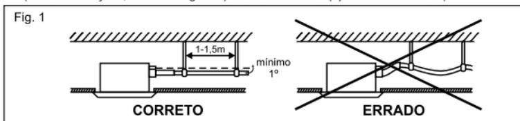
4. Acompanha a unidade um tubo de dreno flexível, uma isolação e uma presilha, que devem ser fixados à saída do dreno da unidade interna. Este tubo flexível permite tanto a inclinação necessária (fig. 1) como a elevação do tubo do dreno (fig. 2).
