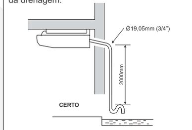
Se houver necessidade de drenagem para cima, adquira e instale uma minibomba de remoção de condensados Elgin.
