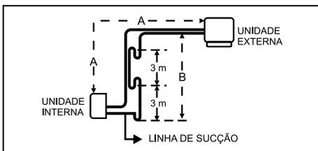
3. Quando a unidade externa for instalada **abaixo** da unidade interna ou no mesmo nível, recomendamos a instalação de tubulação em forma de sifão na linha de sucção, próximo à unidade interna, protegendo o compressor de um possível retorno de fluido refrigerante em estado líquido. A parte superior do sifão deverá estar no mesmo nível da parte mais alto do evaporador.
