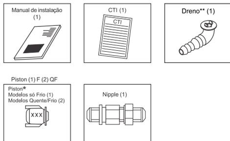
\* Conforme o modelo do produto, o dispositivo de expansão pode ser do tipo tubo capilar ou piston. Esta informação consta na etiqueta de características técnicas da unidade externa.
