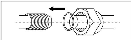
3. Finalmente aperte as conexões utilizando duas chaves, estando uma delas apoiada no tampão da válvula de serviço. Tenha o cuidado de não permitir a torção dos tubos.
