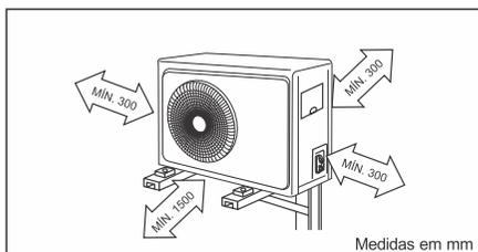
5. A unidade externa deve ser fixada na superfície em que for instalada.
