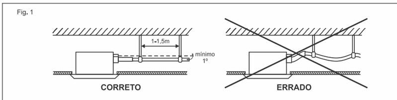
4. Acompanha a unidade um tubo de dreno flexível, uma isolação e uma presilha, que devem ser fixados à saída do dreno da unidade interna. Este tubo flexível permite tanto a inclinação necessária (fig. 1) como a elevação do tubo do dreno (fig. 2).
