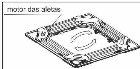
Etapa 2: Remova as tampas de instalação nos quatro cantos deslizando-as para fora.
