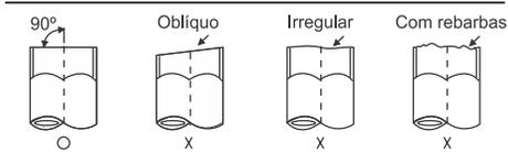
3. Para impedir vazamentos de gás, retire todas as rebarbas do local cortado, utilizando uma lima ou o alargador.
