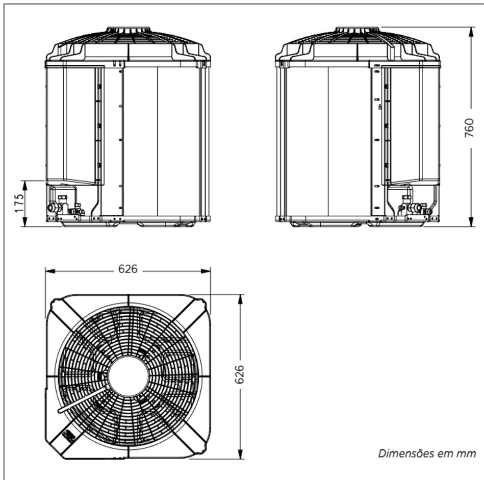
FIG. 6B - DIMENSIONAL UNIDADES CONDENSADORAS 38C\_VD48
