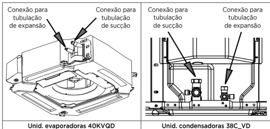
FIG. 26 - CONEXÕES DE INTERLIGAÇÃO
