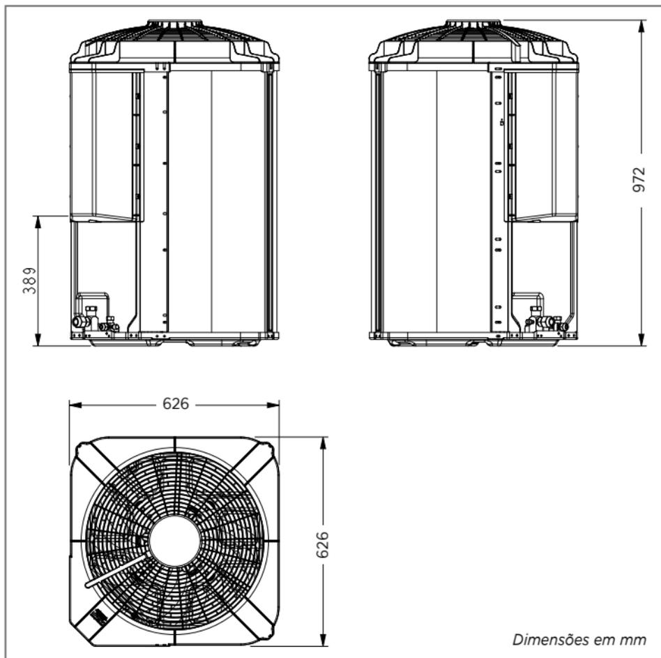
FIG. 6C - DIMENSIONAL UNIDADES CONDENSADORAS 38C\_VD60
