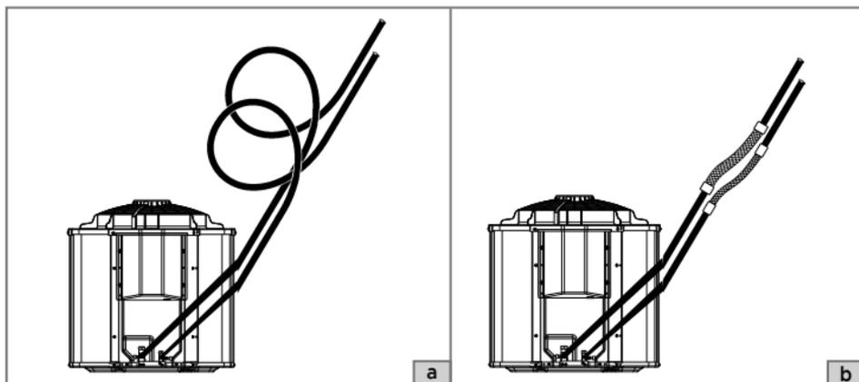
FIG. 25 - INSTALAÇÃO DOS LOOP'S E TUBOS FLEXÍVEIS
