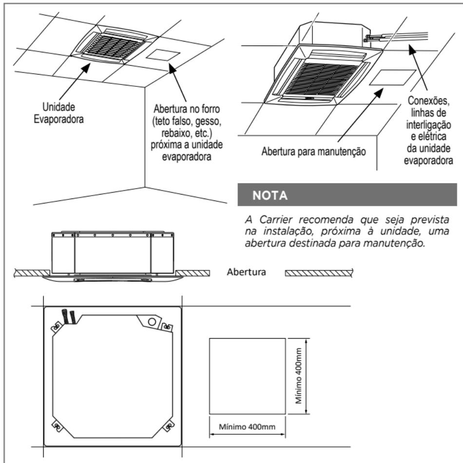
FIG. 13 - ABERTURA PARA MANUTENÇÃO - DIMENSIONAL
