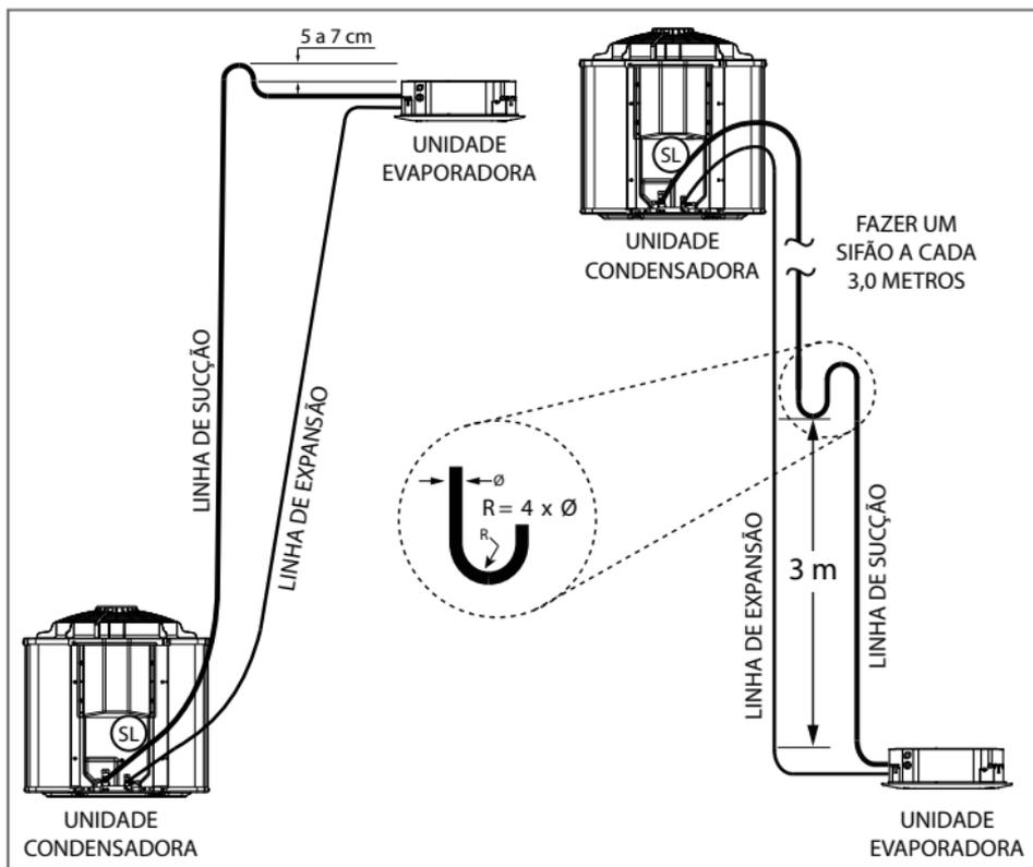
FIG. 24 - INSTALAÇÃO LINHAS DE INTERLIGAÇÃO
