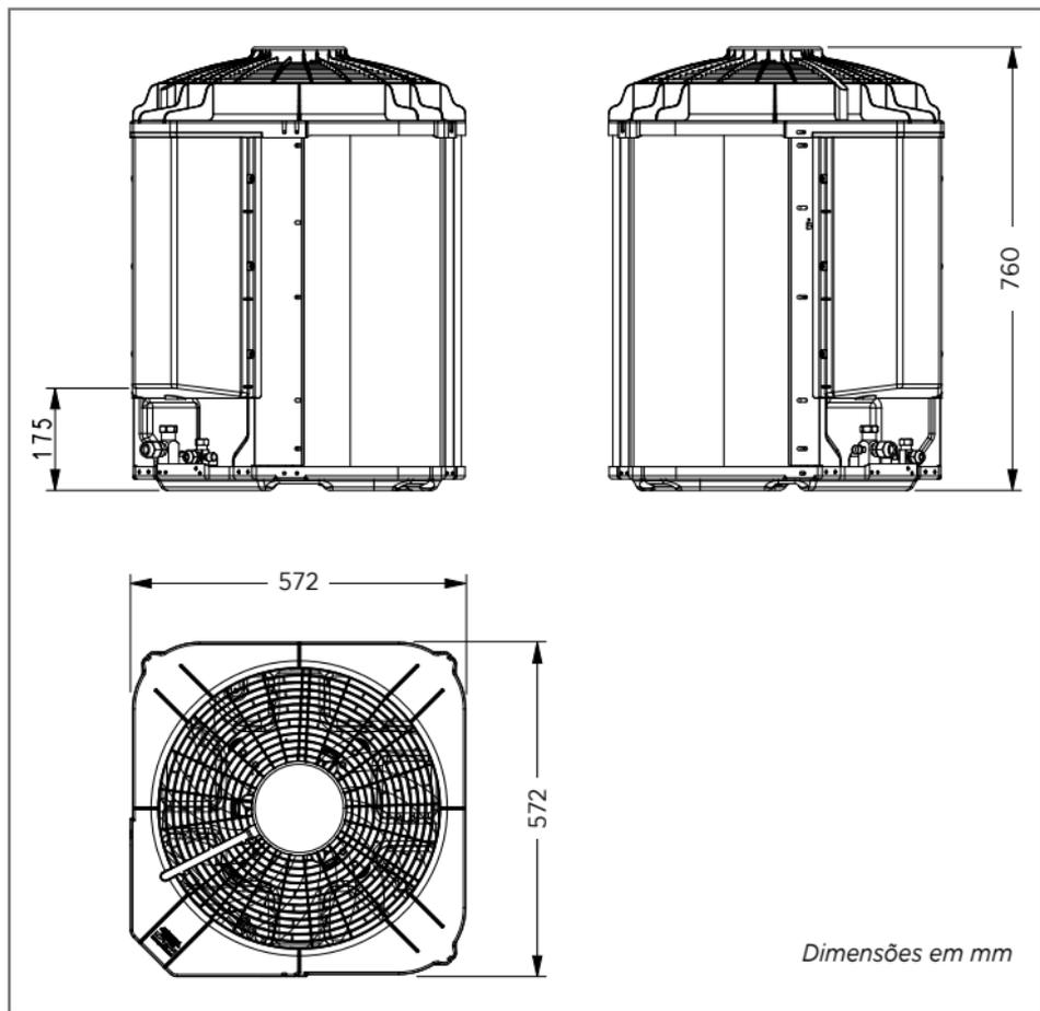
FIG. 6A - DIMENSIONAL UNIDADES CONDENSADORAS 38C\_VD36
