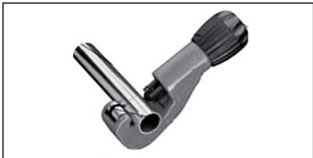
FIG. 33 - CORTADOR DE TUBOS
