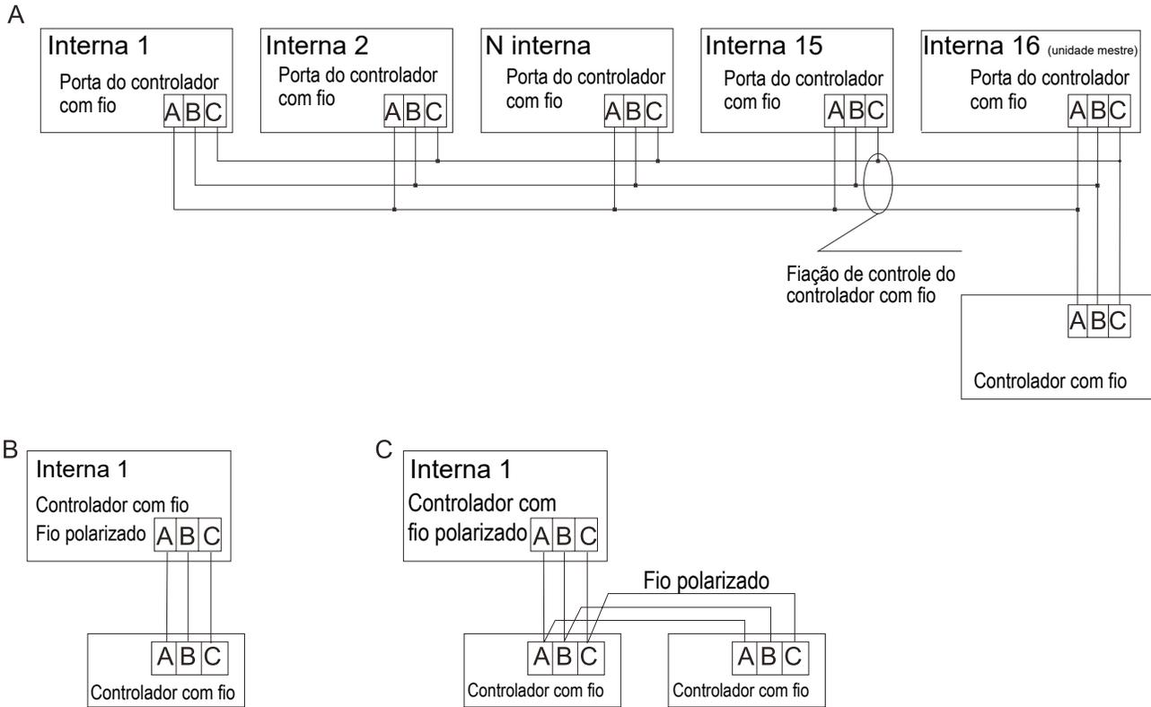
Há três métodos para conectar o controlador com fio e as unidades internas:
