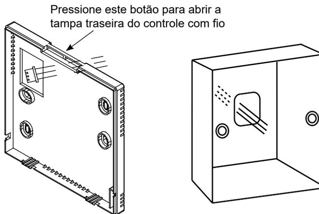
2. Fixe de volta a tampa traseira no suporte. Depois disso, conecte o cabo de comunicação à porta CON1 do controlador com fio. Por fim, coloque a tampa frontal do controlador com fio na tampa traseira para concluir a instalação.
