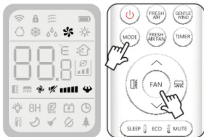
Para ajustar a velocidade do ar pressione o botão (FAN), e selecione conforme a sequência:
