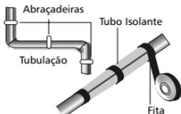
2. Fixe a parte excedente do cabo elétrico na tubulação ou na unidade externa.
