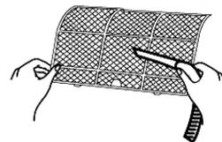
3. Após retirar o filtro da unidade interna, limpe o FILTRO DE AR, utilizando para isto um aspirador de pó ou lavando-o com água; depois deixe-o secar em local seco.
