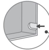
Se a tomada/disjuntor estiver instalado no lado esquerdo do aparelho, essa área da frente plástica deve ser quebrada para a passagem do cabo.
