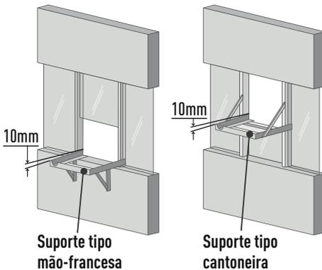
O suporte de aço para o aparelho deverá ter uma pequena inclinação de 10mm (0,5 bolha), e não deve ser fechado, pois há a necessidade de permitir a retirada do dreno pela parte traseira ou inferior do gabinete (veja figura abaixo).
