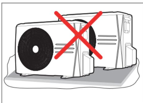
FIG. 2 - EVITAR INSTALAÇÃO EM SEQUÊNCIA
