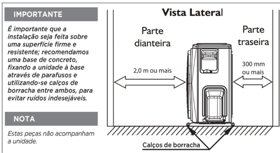
FIG. 4 - ESPAÇAMENTOS E CALÇOS DE BORRACHA
