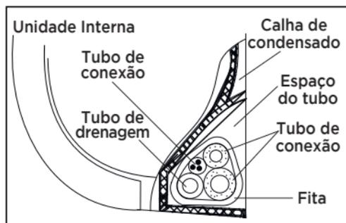
FIG. 9 - TUBO DE CONEXÕES
