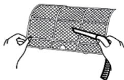
4. Reintroduzir a parte superior do filtro de ar na unidade observando para que a beirada direita e externa estejam perfeitamente alinhadas; recolocar o filtro.
