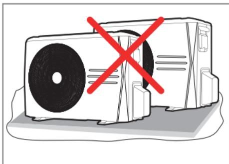
FIG. 2 - EVITAR INSTALAÇÃO EM SEQUÊNCIA
