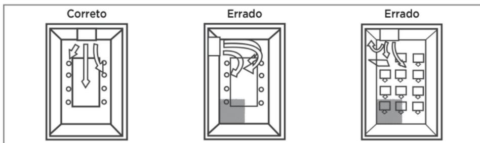
FIG. 5 - POSICIONAMENTO DA UNIDADE EVAPORADORA NO AMBIENTE
