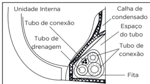
FIG. 8 - TUBO DE CONEXÕES
