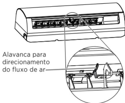
Durante o ajuste deve-se prestar atenção para não colocar os dedos no ventilador, nem no defletor de direção horizontal, cuidando também para não danificar os defletores verticais.
