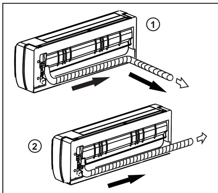
FIG. 9 - DIREÇÕES DAS TUBULAÇÕES
