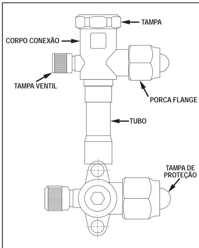
FIG. 17 - VÁLVULA DE SERVIÇO LINHAS SUÇÃO/EXPANSÃO
