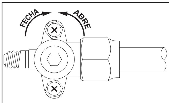
FIG. 18 - VÁLVULA DE SERVIÇO SEM PORCA DE PROTEÇÃO
