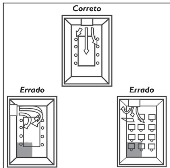
FIG. 6 - POSICIONAMENTO DA UN. INTERNA NO AMBIENTE
