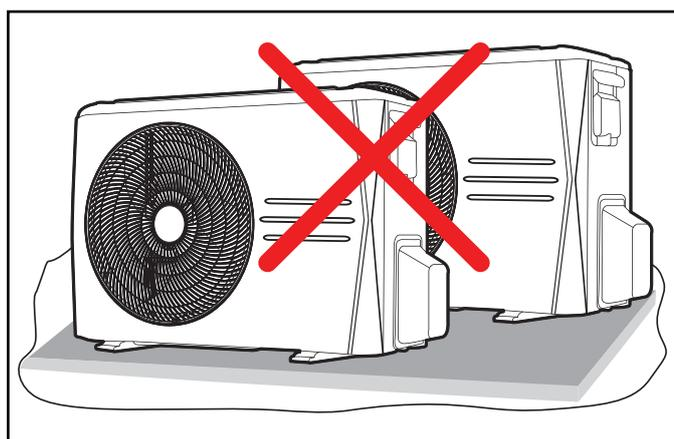
FIG. 1b - EVITAR INSTALAÇÃO EM SEQUÊNCIA
