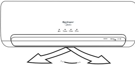
Regular **manualmente** os defletores verticais para alterar a direção do fluxo de ar para esquerda, ao centro ou para direita, movendo a(s) alavanca(s) situada(s) entre os defletores. A quantidade e a posição das alavancas poderá variar conforme o modelo.
