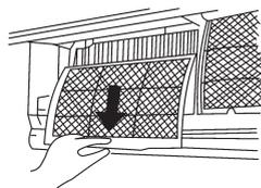
3. Após retirar o filtro da unidade interna, limpe o FILTRO DE AR, utilizando para isto um aspirador de pó ou lavando-o com água; depois deixe-o secar em local seco.
