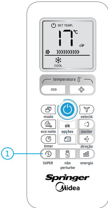
Pressionar a tecla **SUPER** faz com que a unidade opere em sua capacidade máxima até atingir a temperatura configurada da seguinte forma:
