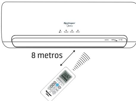
Posicionar o controle remoto de modo que os sinais enviados possam alcançar facilmente o receptor da unidade interna (a uma distância máxima de 8 metros).
