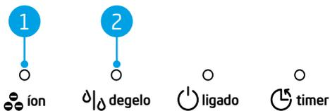
O LED **ion** em combinação com o LED **degelo** piscam conforme a necessidade de limpeza ou substituição do filtro de ar.
