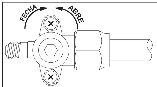
FIG. 18 - VÁLVULA DE SERVIÇO SEM PORCA DE PROTEÇÃO
