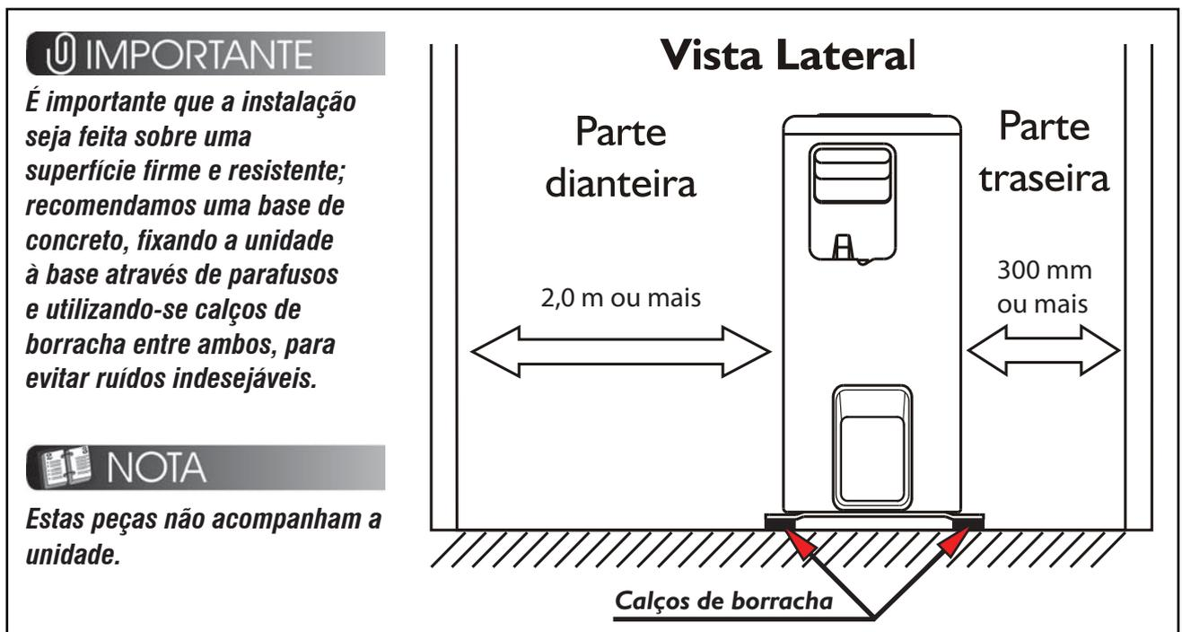
FIG. 4 - ESPAÇAMENTOS E CALÇOS DE BORRACHA
