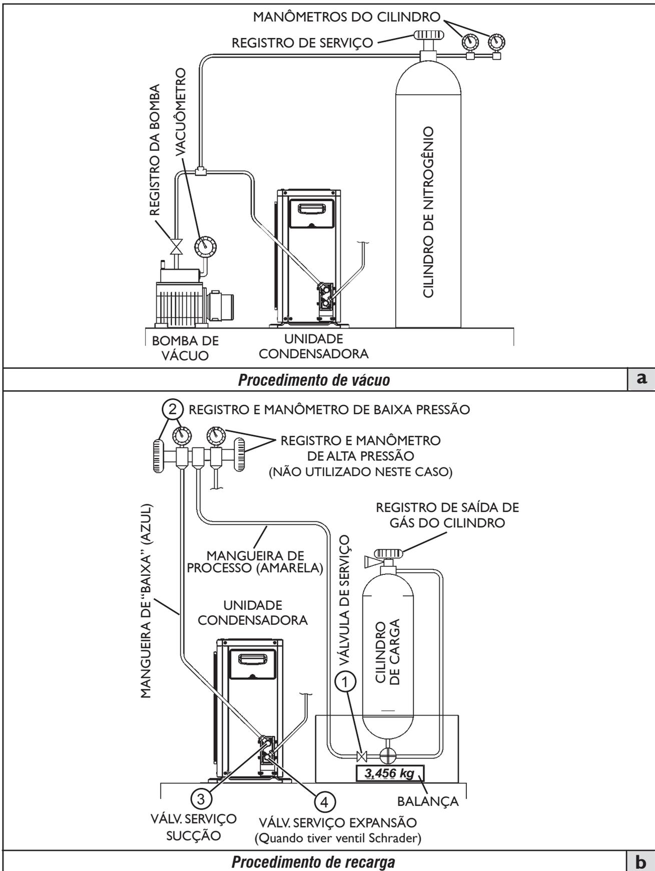
FIGURA 30 - PROCEDIMENTOS DE VÁCUO E RECARGA
