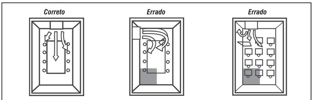
FIG. 6 - POSICIONAMENTO DA UNIDADE EVAPORADORA NO AMBIENTE
