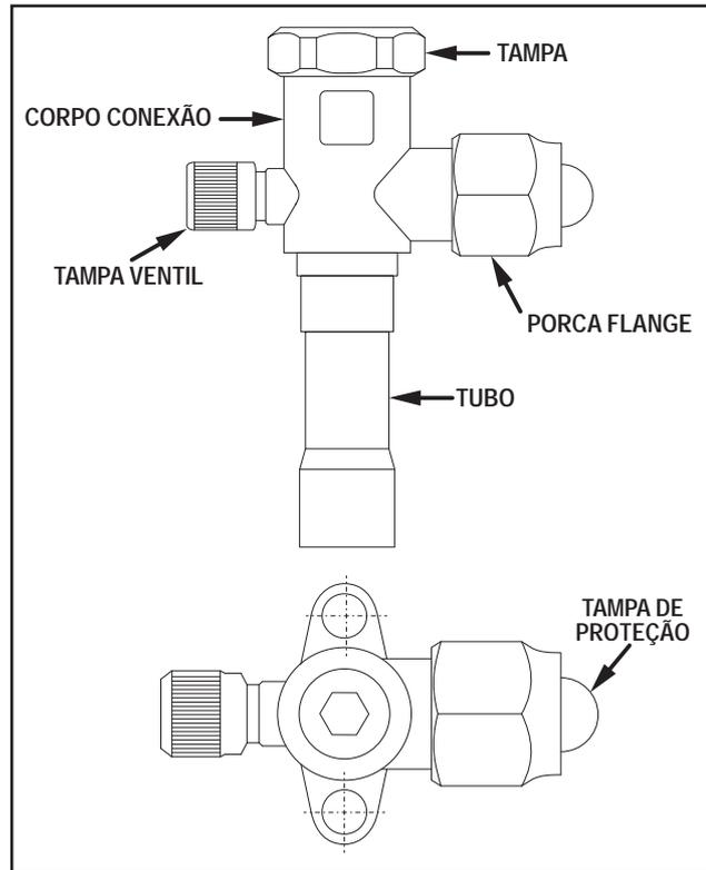
FIG. 17 - VÁLVULA DE SERVIÇO LINHAS SUÇÇÃO/EXPANSÃO
