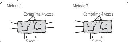
5 Envolve-o com duas ou mais voltas de fita isoladora e coloque o tubo de contração no meio da fita isoladora. São necessárias três ou mais camadas de isolamento.
