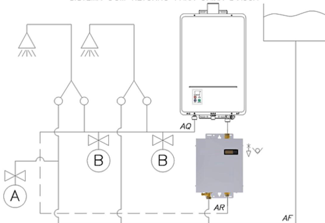
SISTEMA SEM RETORNO PARA CAIXA D'ÁGUA
