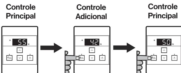
Se a temperatura setada no controle principal for maior que 50°C e a função 'Priority' for transferida para um controle remoto adicional e transferida novamente para o principal, a temperatura configurada no controle principal é reduzida para 50°C. Esta é uma função de segurança.
