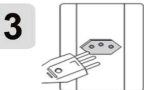
**3** Certifique a compatibilidade de tensão entre a tomada e o aparelho, então ligue o plugue do aparelho na tomada.
