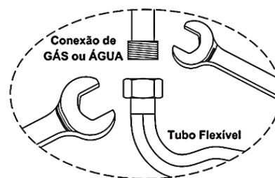
Torque máximo nas conexões: 200kgf.cm
