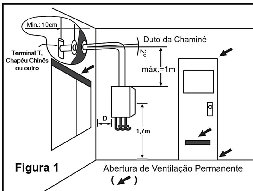
Exemplos de Abertura de Ventilação Permanente
