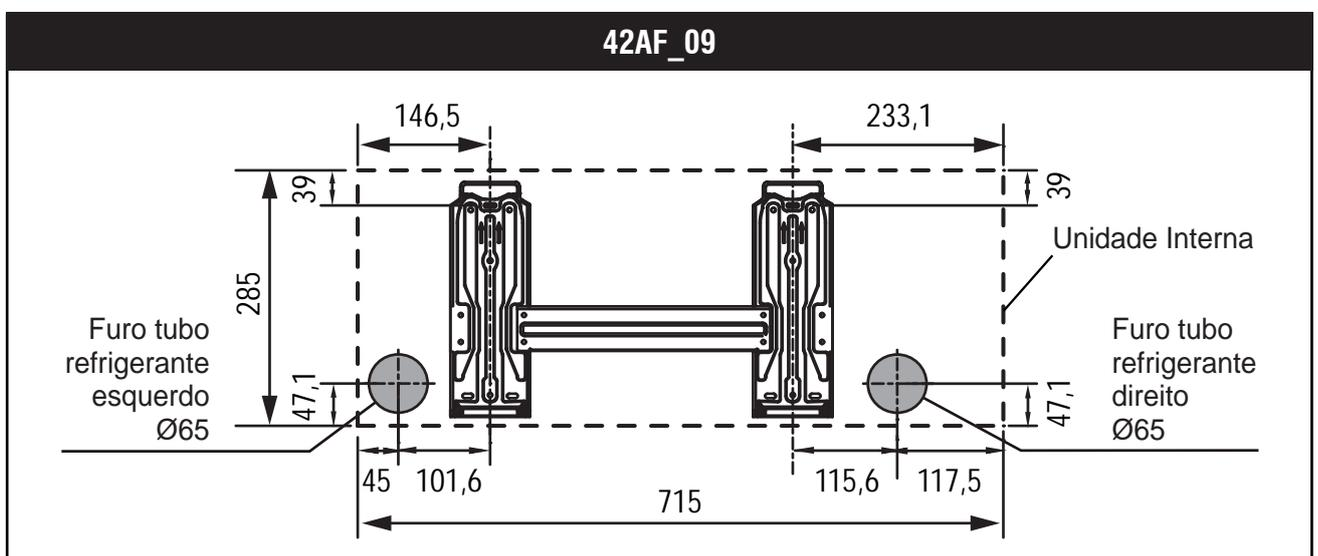
FIG. 21a - SUPORTES DE MONTAGEM
