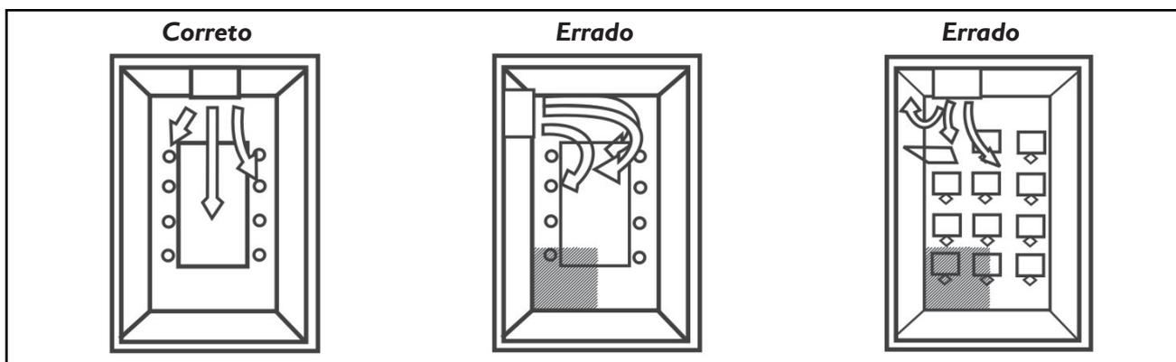
FIG. 13 - POSICIONAMENTO DA UNIDADE EVAPORADORA NO AMBIENTE
