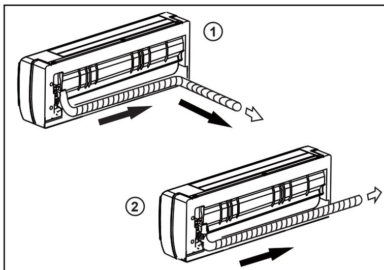
FIG. 16 - DIREÇÕES DAS TUBULAÇÕES
