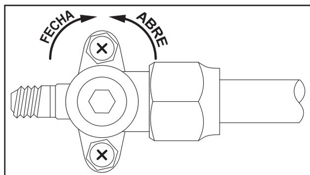
FIG. 25 - VÁLVULA DE SERVIÇO SEM PORCA DE PROTEÇÃO
