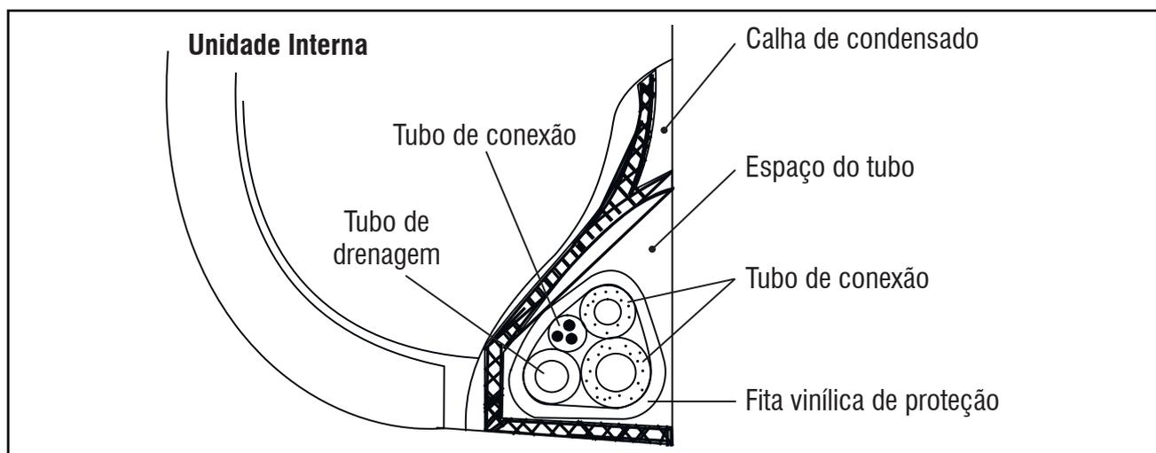
FIG. 17 - TUBOS DE CONEXÃO E DRENAGEM
