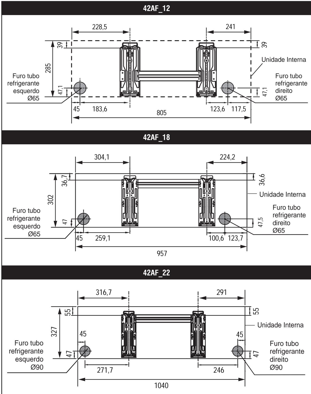
FIG. 21b - SUPORTES DE MONTAGEM
