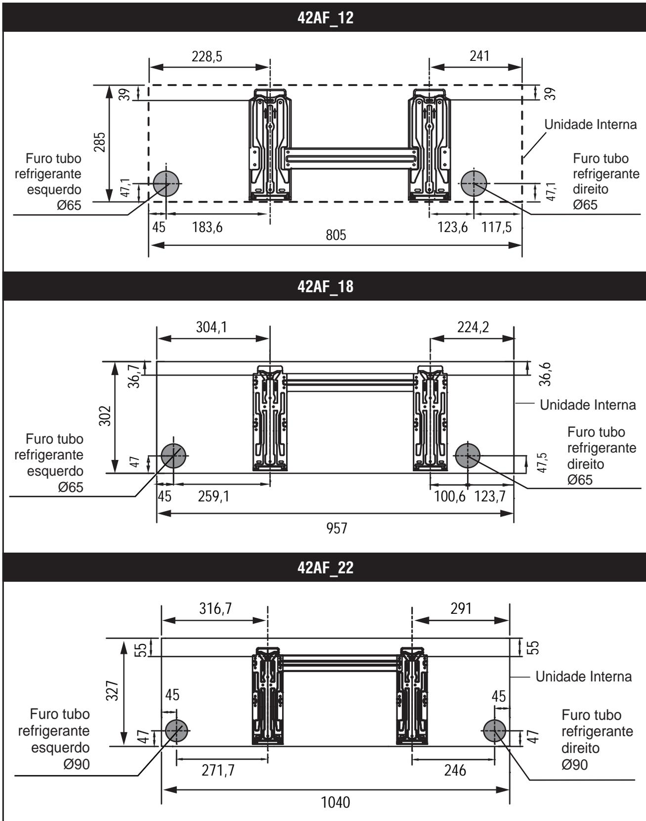
FIG. 20b - SUPORTES DE MONTAGEM
