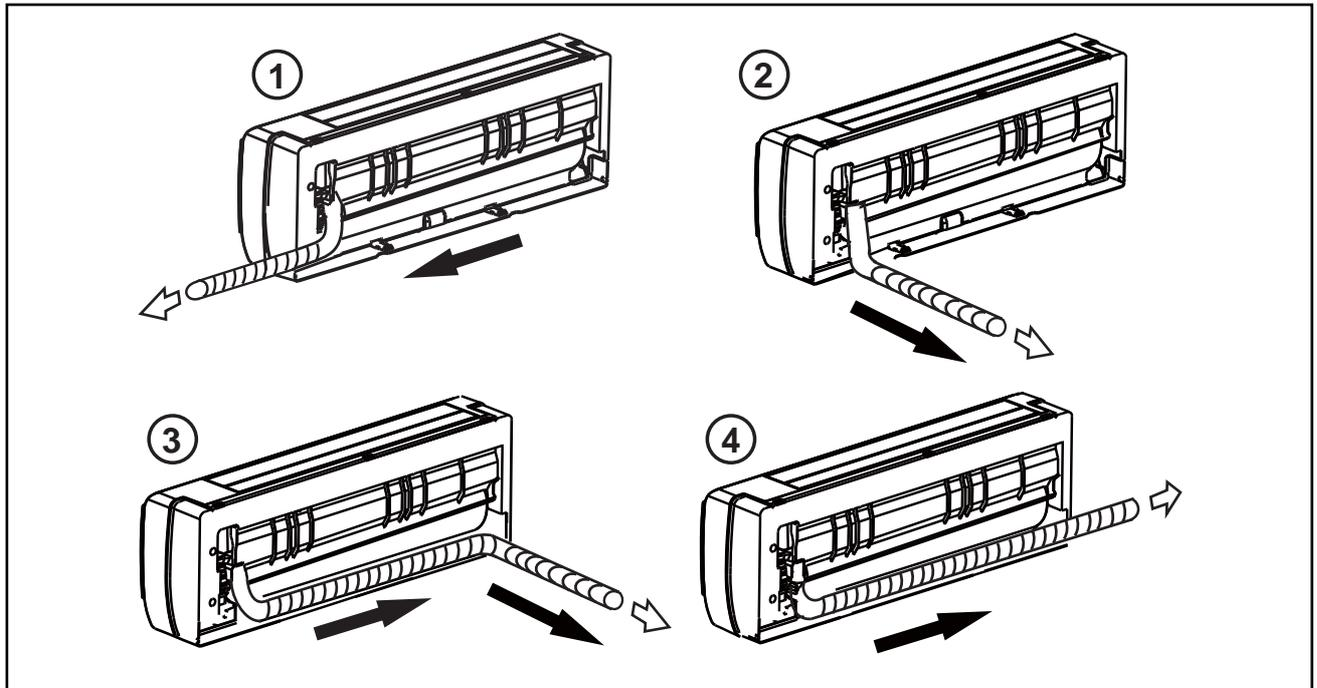
FIG. 15 - DIREÇÕES DAS TUBULAÇÕES
