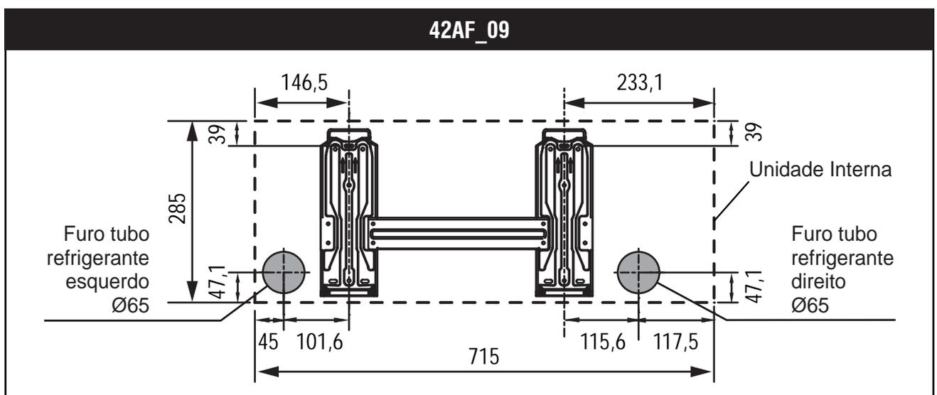
FIG. 20a - SUPORTES DE MONTAGEM
