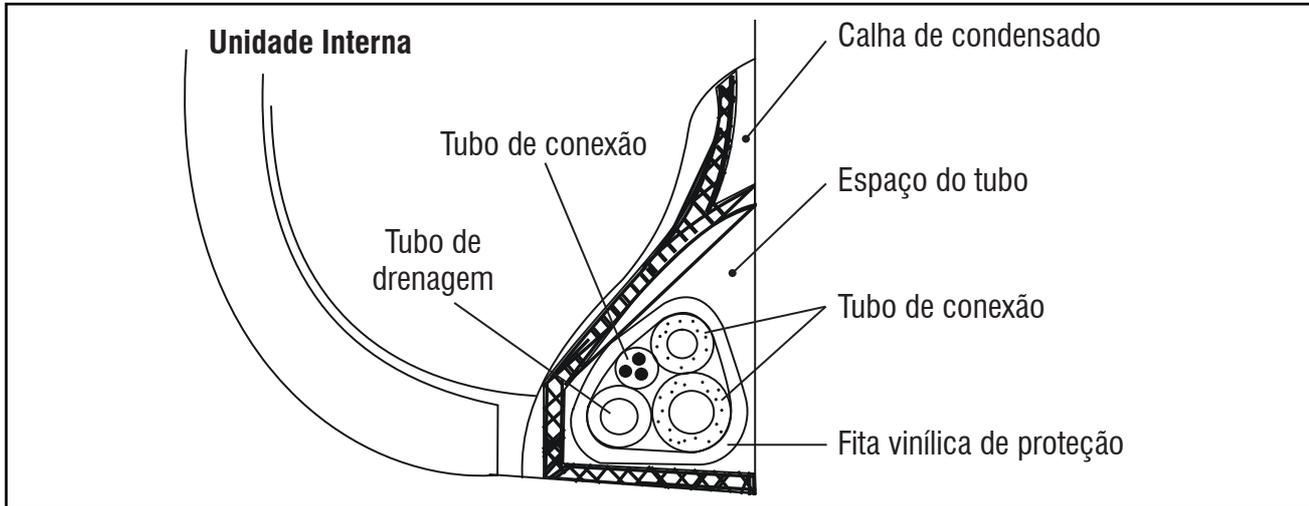
FIG. 16 - TUBOS DE CONEXÃO E DRENAGEM
