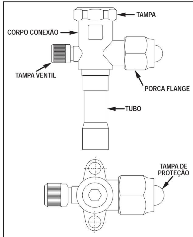
FIG. 23 - VÁLVULA DE SERVIÇO LINHAS SUÇÇÃO/EXPANSÃO
