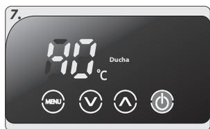
O aquecedor retornará automaticamente para a função original ducha e após 20 minutos de inatividade entrará em modo stand-by. Os valores de volume e temperatura escolhidos anteriormente ficarão memorizados para sua comodidade, para a próxima vez em que utilizar a banheira.
