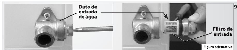
4. Com a ajuda de uma chave de fenda retirar o filtro de tela metálica posicionado no interior do duto de entrada de água do produto (fig. 9).
