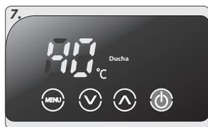
O aquecedor retornará automaticamente para a função original ducha e após 20 minutos de inatividade entrará em modo stand-by. Os valores de volume e temperatura escolhidos anteriormente ficarão memorizados para sua comodidade, para a próxima vez que utilizar a banheira.
