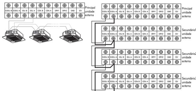
O terminal GND no principal PCB é um '(\*)' terminal para contato seco. Não é a altura para fazer ligações de terra.
