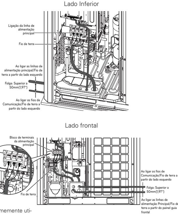
Fixe firmemente utilizando uma braçadeira ou fixador para não se deslocar
