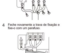
4 Feche novamente a trava de fixação e fixe-o com um parafuso.
