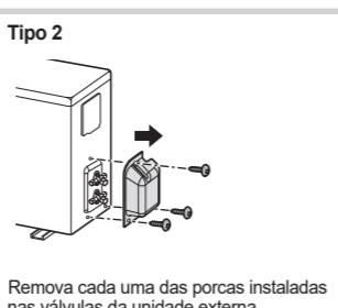
2 Remova cada uma das porcas instaladas nas válvulas da unidade externa.
