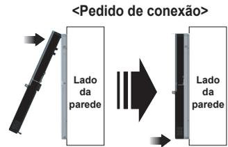
Separar o controle remoto da placa de configuração, conforme figura ao lado. Após inserir no furo inferior a chave de fenda e girar no sentido horário, o controle remoto é separado.
