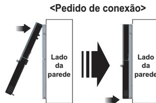
Separar o controle remoto da placa de configuração, conforme figura ao lado. Após inserir no furo inferior a chave de fenda e girar no sentido horário, o controle remoto é separado.
