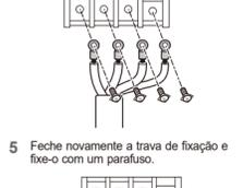
5 Feche novamente a trava de fixação e fixe-o com um parafuso.
