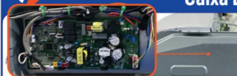
Caixa elétrica fabricada em chapa de aço, com tampa de proteção dos componentes
