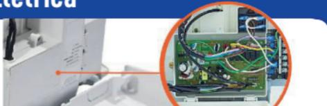
Caixa elétrica do conjunto ventilação, pode ocasionar defeitos não possui facilidade de conexão
