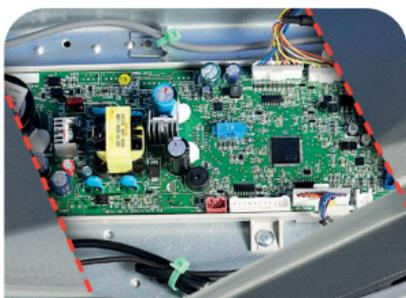
As placas eletrônicas são revestidas com tripla camada de resina protetora anticorrosão, ocasionadas pela maresia e umidade.
