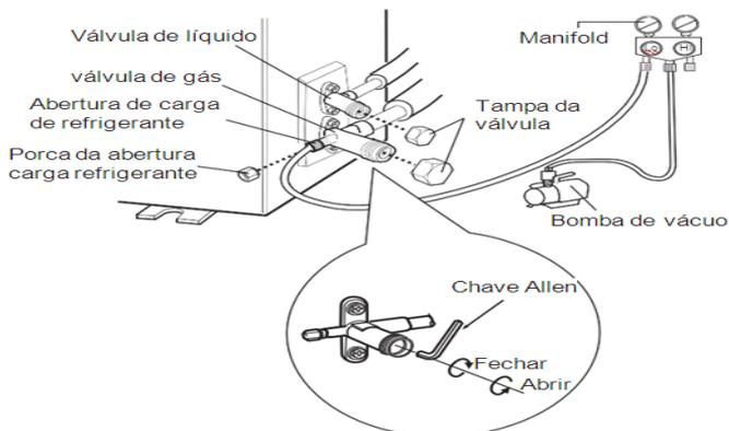
3. Utilize vacuômetro pra medição do vácuo. A faixa a ser atingida deve situar entre 33,3 Pa (250  $\mu\text{mHg}$ ) e 66,7 Pa (500  $\mu\text{mHg}$ ).
