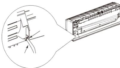
3. Remova o grampo de cabo, conecte o cabo de conexão de energia no terminal de fiação de acordo com a cor, aperte o parafuso e, em seguida, fixe o cabo de conexão de energia com o grampo de cabo.
