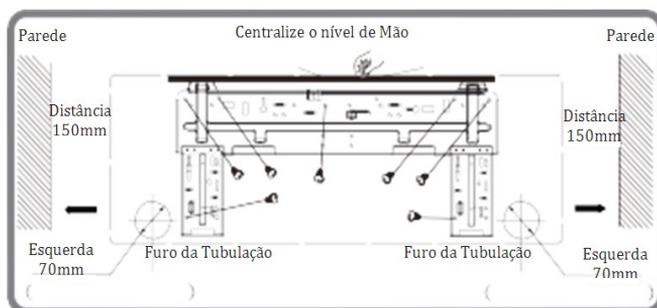
2. Abra um furo de tubulação com o diâmetro de 55mm ou 70mm na posição do tubo de saída selecionada. Para uma boa drenagem, incline o furo da tubulação na parede ligeiramente para baixo, para o lado externo, com o ângulo de 5-10°.
