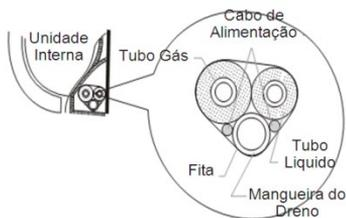
2. Ao prendê-los, reserve um determinado comprimento da mangueira de drenagem e do cabo de alimentação para fixação. Ao prendê-los em um determinado nível, separe a alimentação interna e, então, separe a mangueira de drenagem.
