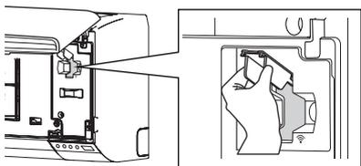
4. Ligue o adaptador WLAN à ranhura de ligação da unidade interior na direção mostrada na figura.
