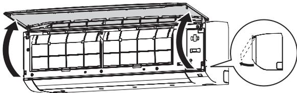
3. Abra a tampa do adaptador WLAN até que ela se encaixe.
