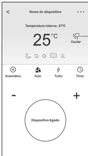
A direção do fluxo de ar pode ser ajustada no modo de oscilação automática utilizando-se a função **OSCILAR**. Neste modo, a posição da aleta de direção do fluxo de ar variará entre o maior e o menor ângulo possível, de maneira contínua. Para isso será necessário seguir os passos abaixo:
