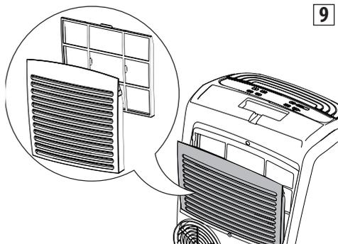
Para retirar o pó depositado no filtro use um aspirador. Se estiver muito sujo, mergulhe-o em água morna e enxágue-o várias vezes. A temperatura da água deve ser mantida abaixo dos 40°C. Depois de lavá-lo, deixe o filtro secar.
