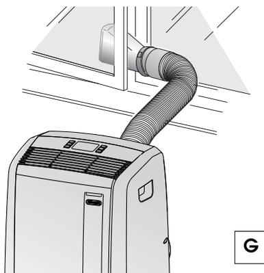
Limite ao mínimo o comprimento e as curvas dos tubos de ar, evitando torcê-los.
