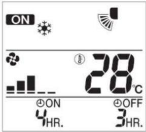
Quando o timer é programado para parar o sistema após 3 horas e iniciar o condicionador de ar após 4 horas, o condicionador de ar irá parar após 3 horas e, em seguida, 1 hora depois, o condicionador de ar será iniciado.
