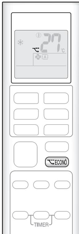
A operação ECONÔ permite um funcionamento eficiente, limitando o consumo máximo de energia.
