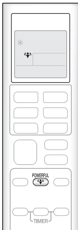
A operação POTENTE maximiza rapidamente o efeito de refrigeração (aquecimento) em qualquer modo de operação. Neste modo, o ar condicionado funciona em sua capacidade máxima.
