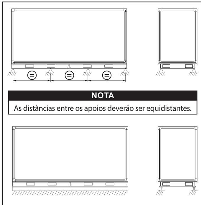
Fig. 10 - Instalação típica - Unidades com base metálica
