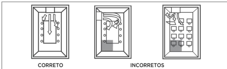
FIG. 12 - POSIÇÃO DA EVAPORADORA NO AMBIENTE
