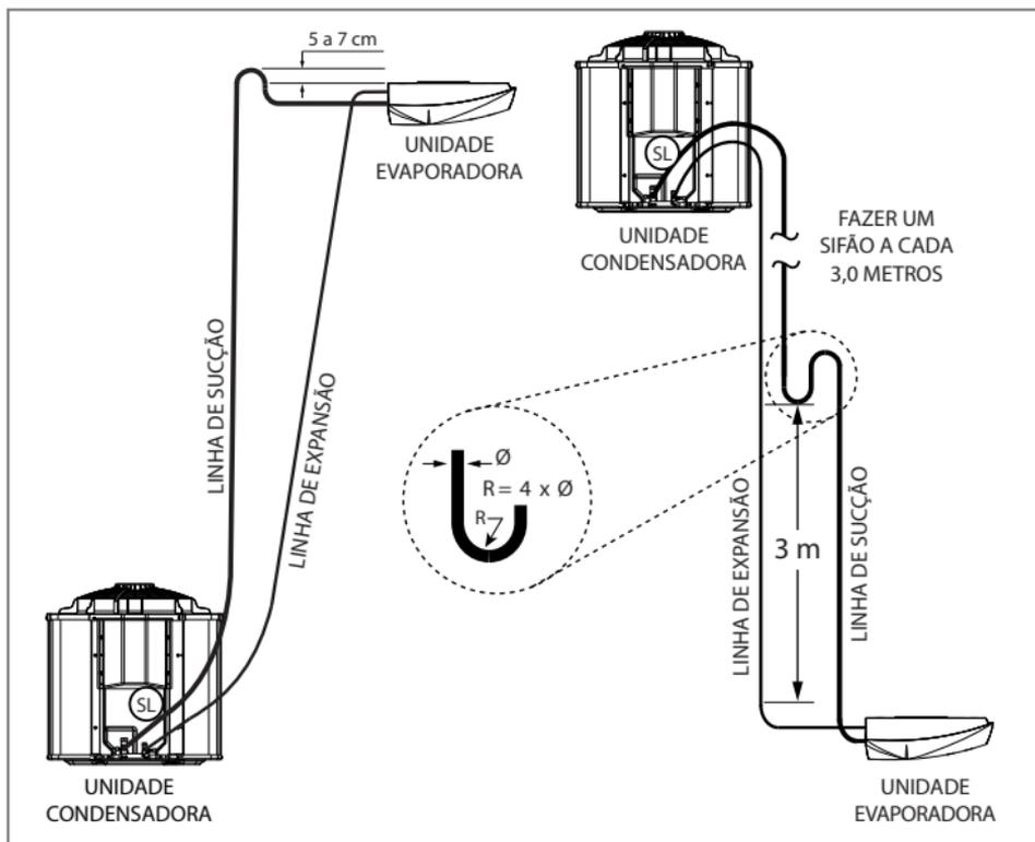
FIG. 19 - INSTALAÇÃO LINHAS DE INTERLIGAÇÃO
