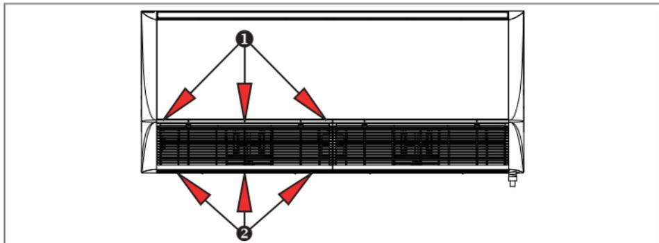
FIG. 15 - POSIÇÃO DOS PARAFUSOS PARA DESMONTAGEM DAS GRELHAS
