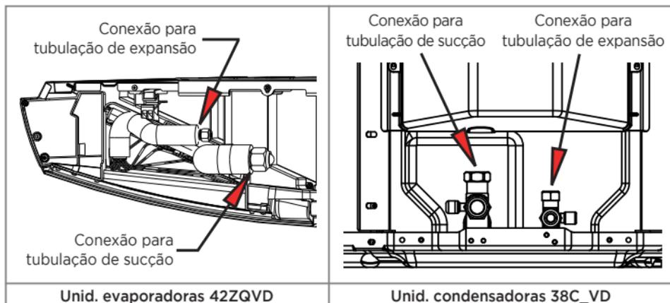
FIG. 21 - CONEXÕES DE INTERLIGAÇÃO
