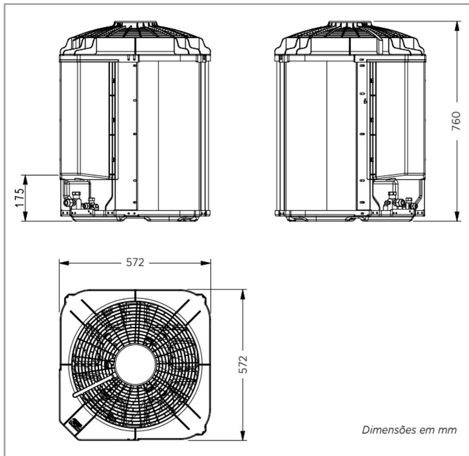
FIG. 7 - DIMENSIONAL UNIDADES CONDENSADORAS 38C\_VD30 / 38C\_VD36
