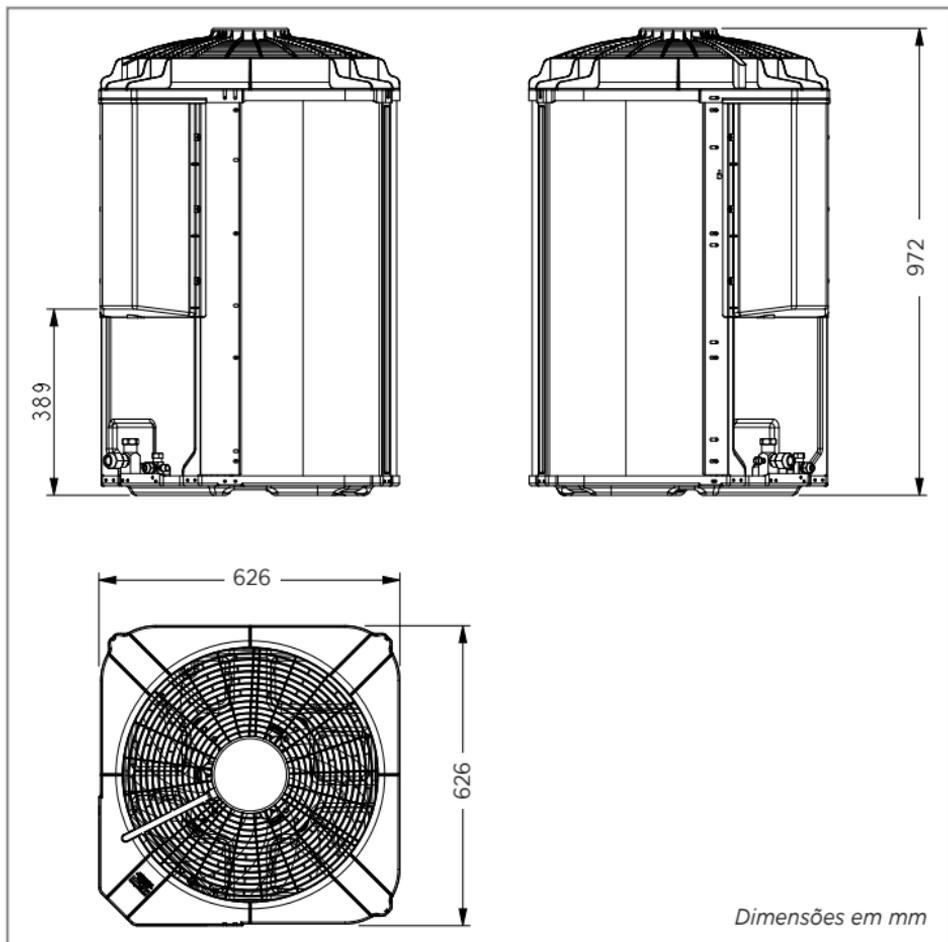
FIG. 9 - DIMENSIONAL UNIDADES CONDENSADORAS 38C\_VD60
