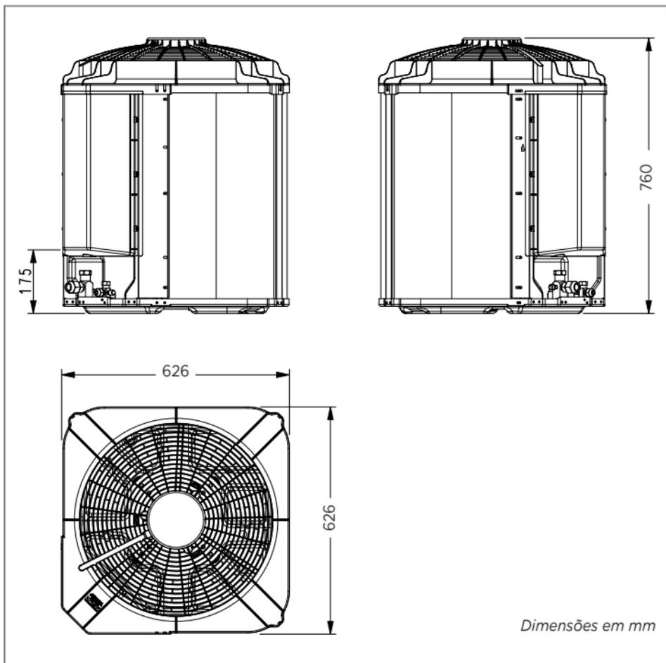
FIG. 8 - DIMENSIONAL UNIDADES CONDENSADORAS 38C\_VD48
