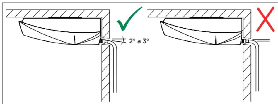
FIG. 17 - INCLINAÇÃO DRENAGEM
