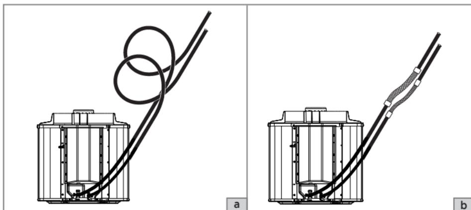
FIG. 20 - INSTALAÇÃO DOS LOOP'S E TUBOS FLEXÍVEIS
