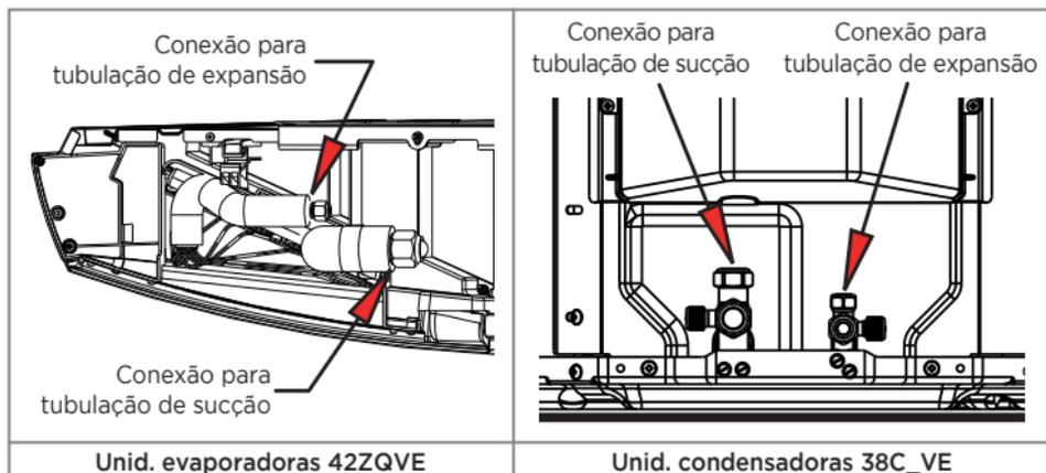
FIG. 21 - CONEXÕES DE INTERLIGAÇÃO
