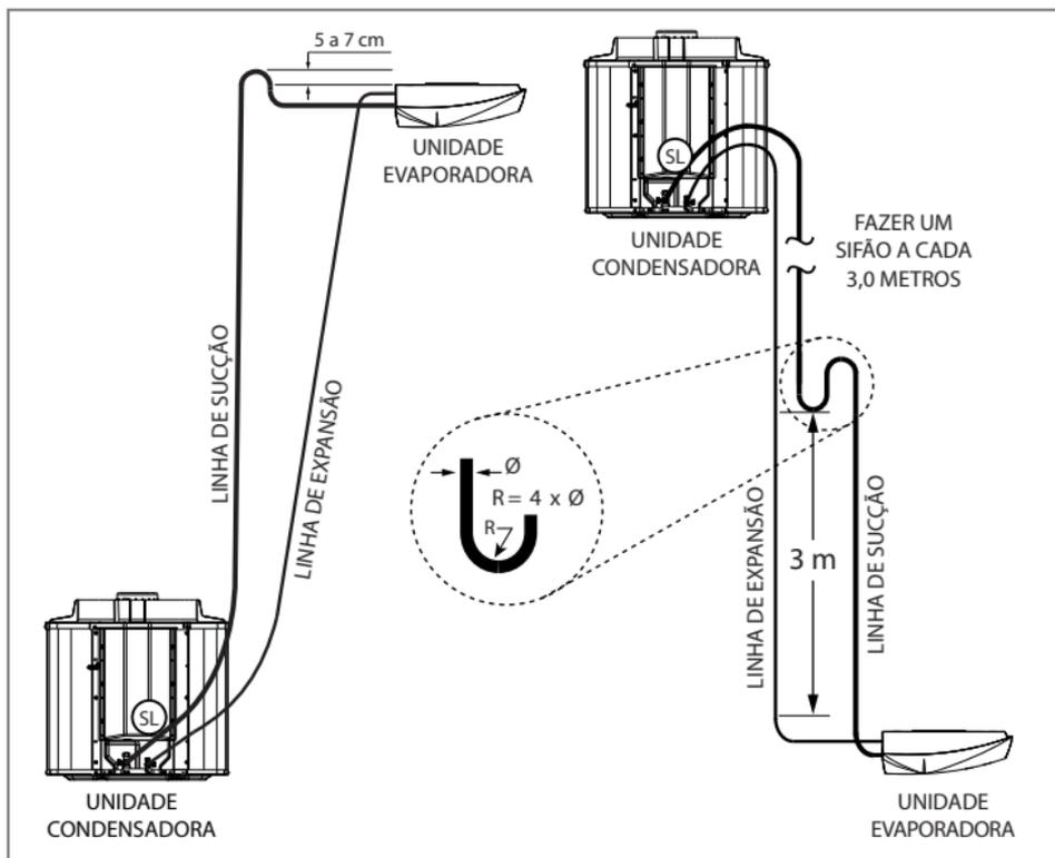
FIG. 19 - INSTALAÇÃO LINHAS DE INTERLIGAÇÃO
