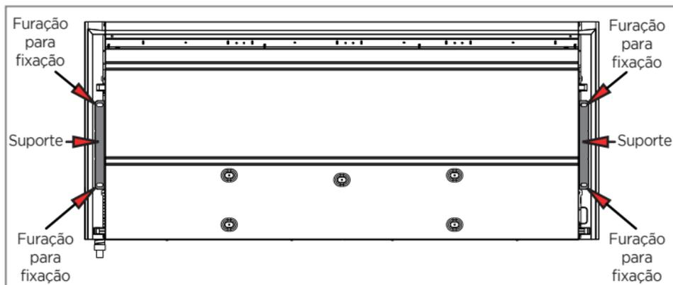
FIG. 13 - SUPORTES E FURAÇÃO PARA FIXAÇÃO
