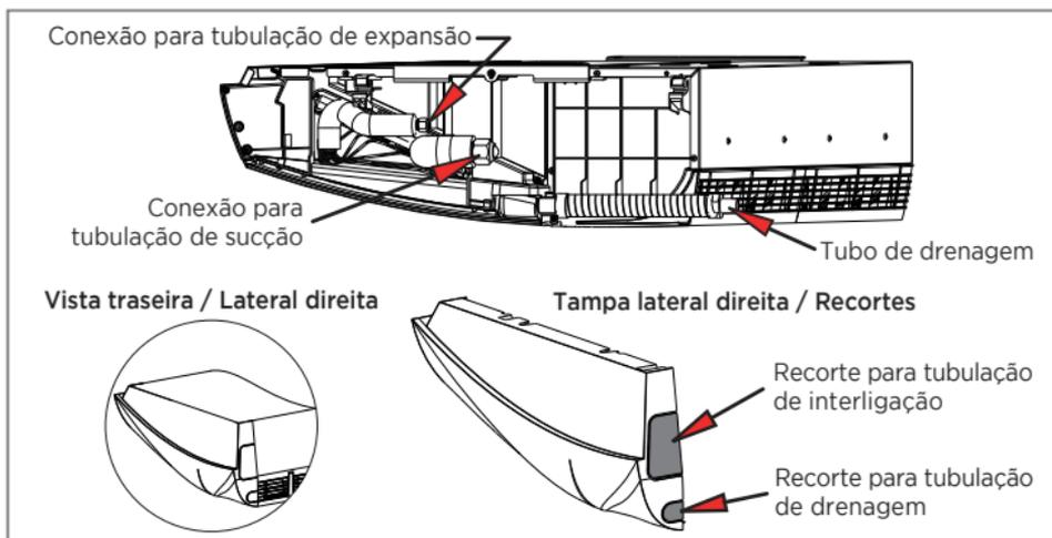
FIG. 16 - TUBULAÇÕES DE INTERCONEXÃO E DRENAGEM
