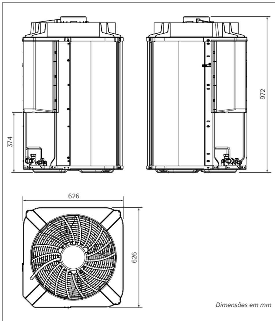
FIG. 9 - DIMENSIONAL UNIDADES CONDENSADORAS 38CQVE60
