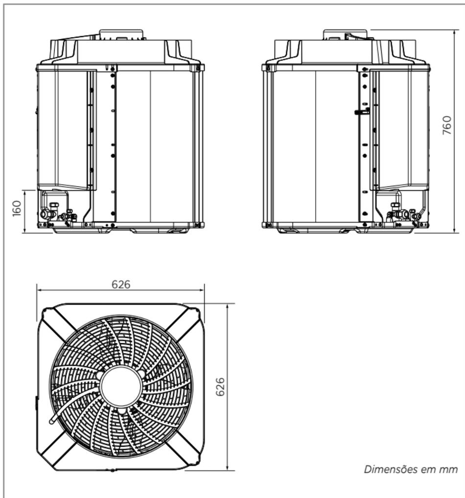
FIG. 8 - DIMENSIONAL UNIDADES CONDENSADORAS 38CQVE48 / 38CCVE60
