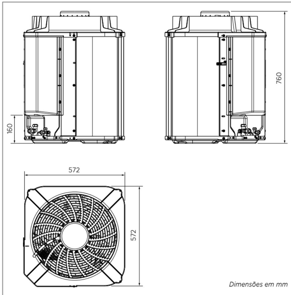
FIG. 7 - DIMENSIONAL UNIDADES CONDENSADORAS 38C\_VE30 / 38C\_VE36 / 38CCVE48
