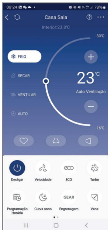
2. Você poderá controlar funções da unidade, tais como ligar/desligar, modo de operação, temperatura, velocidade do ventilador, entre outras funções.
