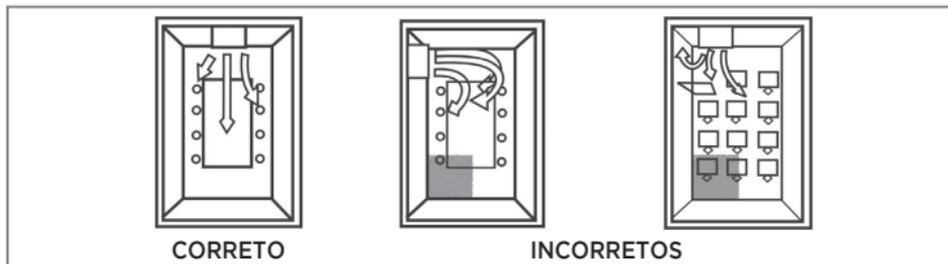
FIG. 12 - POSIÇÃO DA EVAPORADORA NO AMBIENTE
