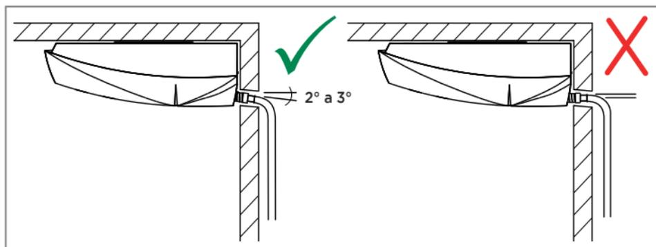
FIG. 17 - INCLINAÇÃO DRENAGEM
