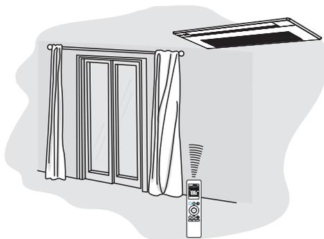
Posicionar o controle remoto de modo que os sinais enviados possam alcançar facilmente o receptor da unidade interna, a uma distância máxima de 8 metros, considerando-se que não haja barreiras entre o receptor e o controle.
