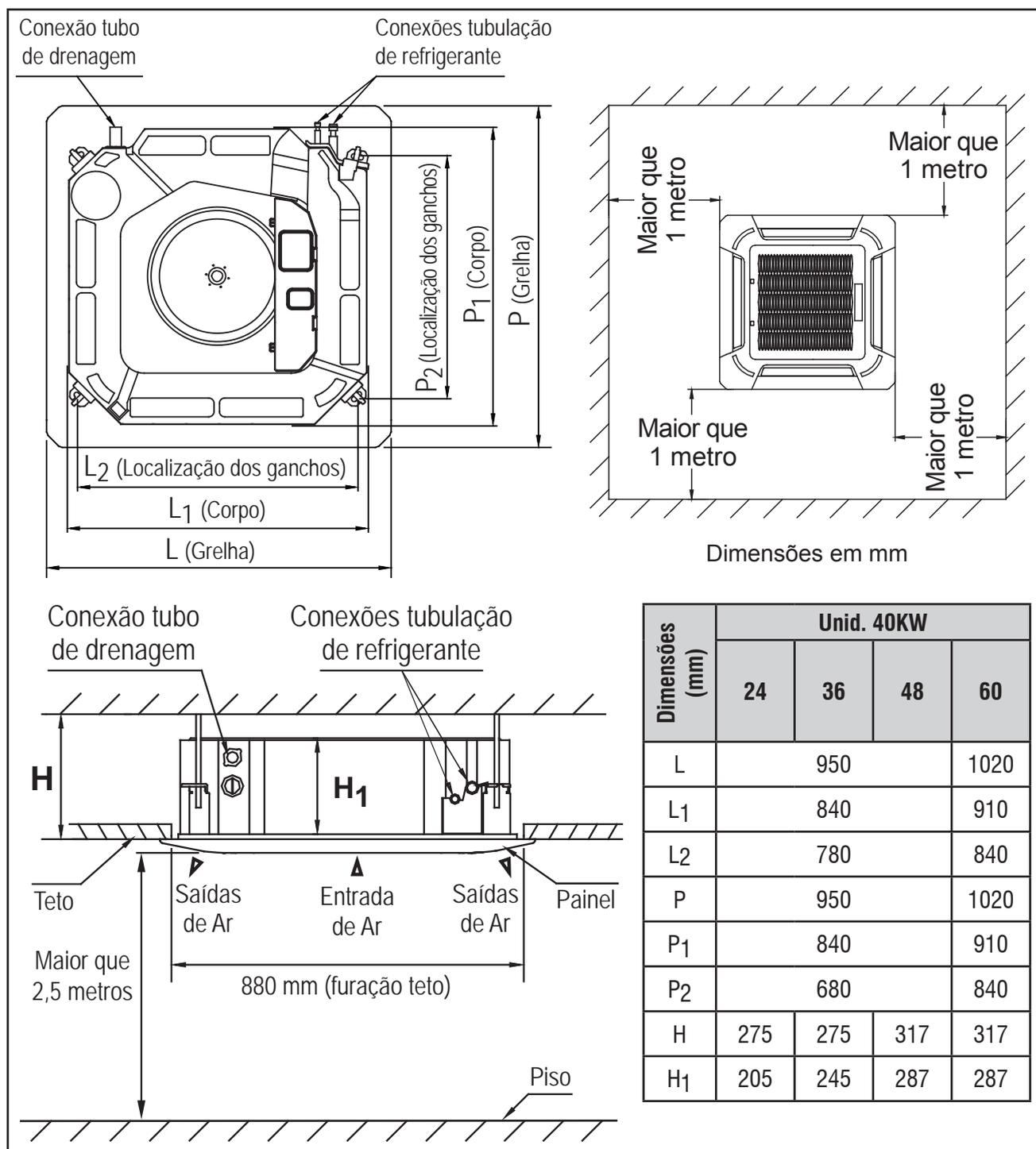
FIG. 17 - DIMENSIONAL E ESPAÇAMENTOS MÍNIMOS 40KW\_24 / 36 / 48 / 60
