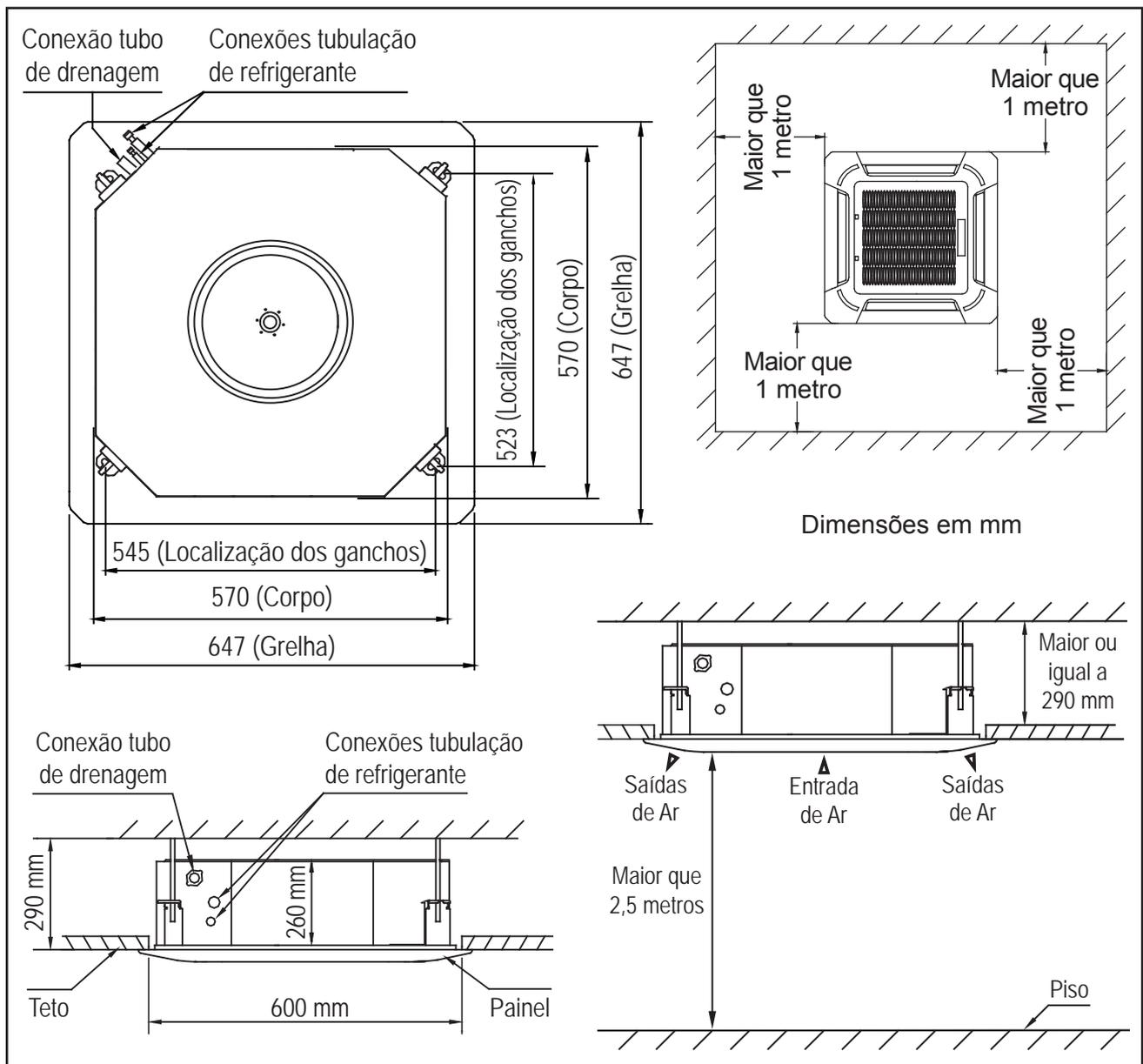
FIG. 16 - DIMENSIONAL E ESPAÇAMENTOS MÍNIMOS 40KW\_18
