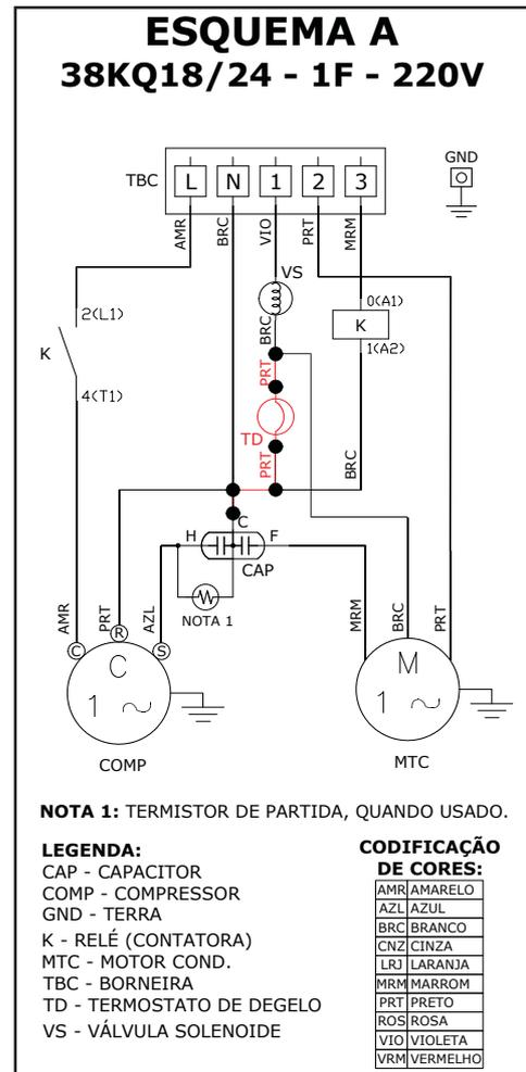
5. Desconecte dois cabos brancos do borne C do capacitor CAP.
