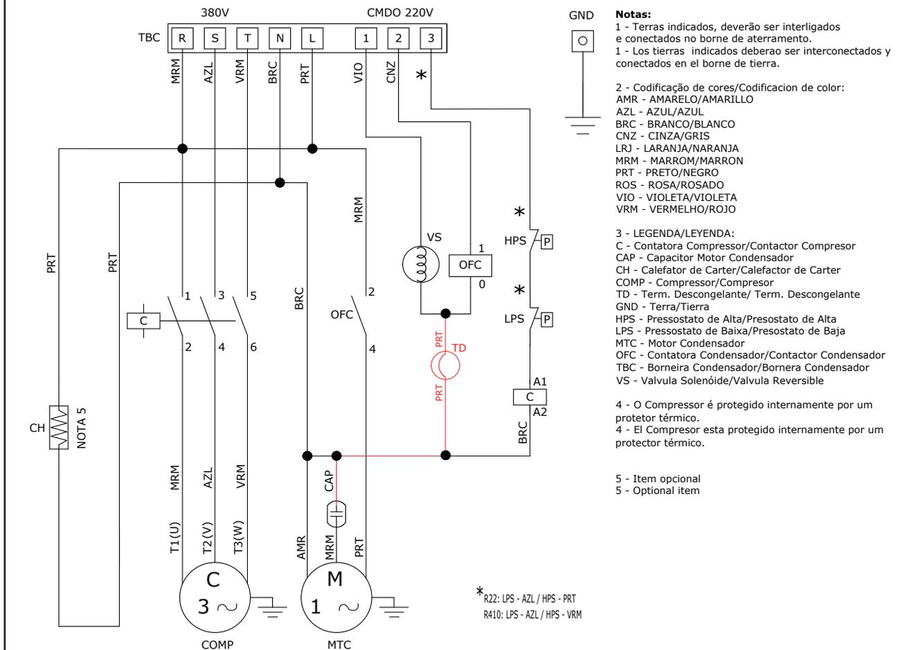
5. Desconecte o cabo branco do borne 0 (ou A2) do relé OFC.
