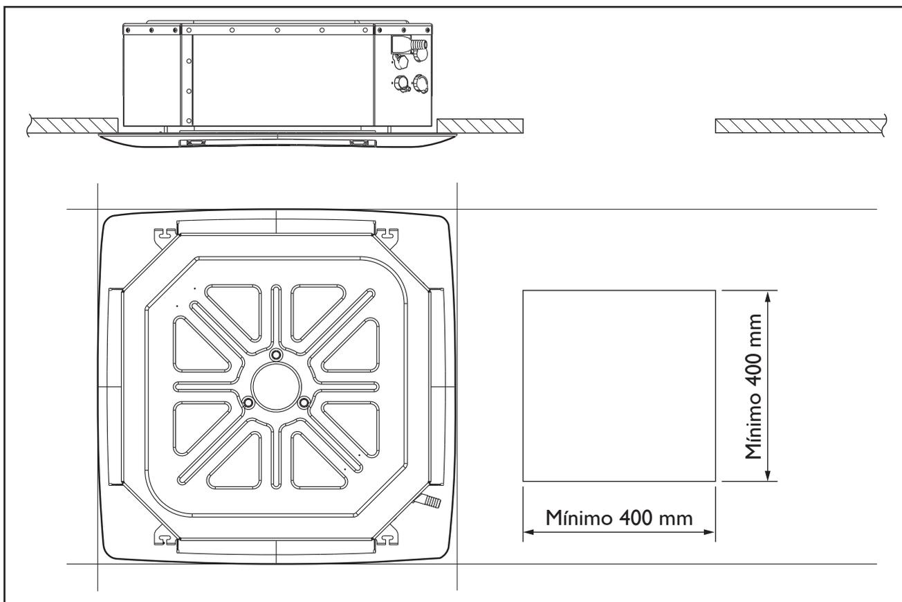
FIG. 22 - ABERTURA PARA MANUTENÇÃO - DIMENSIONAL
