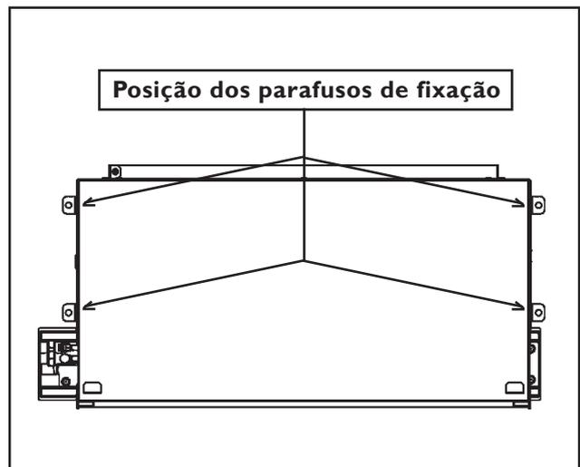
FIG. 18 - MONTAGEM DO SUPORTE DE FIXAÇÃO
