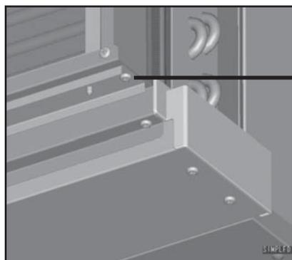
Retire o parafuso indicado na figura e repita este procedimento na outra extremidade.
