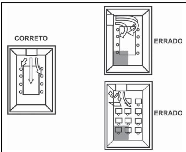
FIG. 17 - POSIÇÃO DA EVAPORADORA NO AMBIENTE
