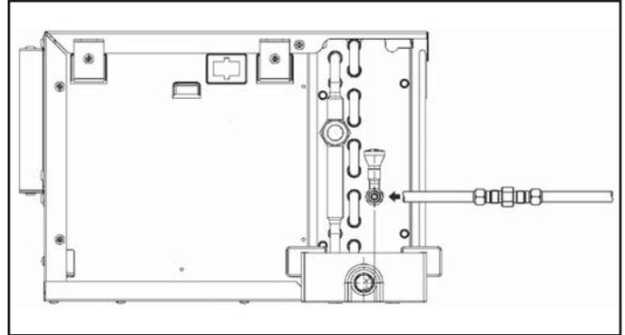
FIG. 44 - INSTALAÇÃO DO KIT SISTEMA DE EXPANSÃO (ACCURATOR)
