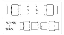
• Conecte as duas extremidades dos tubos de sucção e expansão, já com as porcas e flanges, às respectivas válvulas de serviço da unidade interna e externa.
